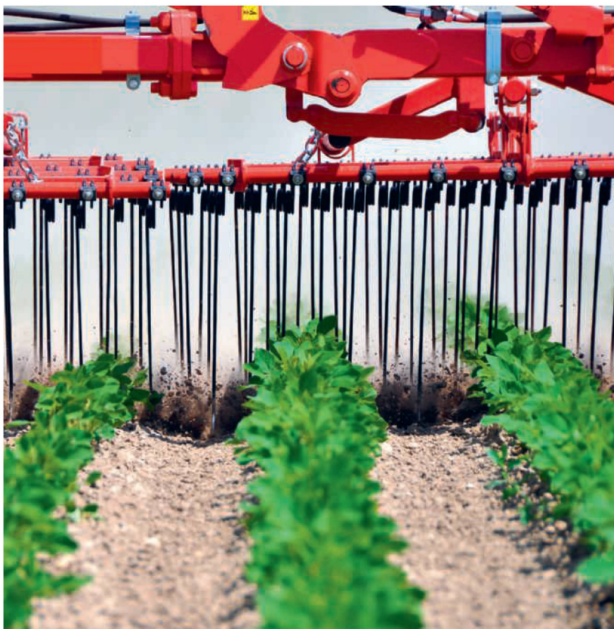
Die Striegelwirkung besteht zu 70% im Verschütten und zu 30% im Ausreissen der Unkräuter. Bild: zvg
