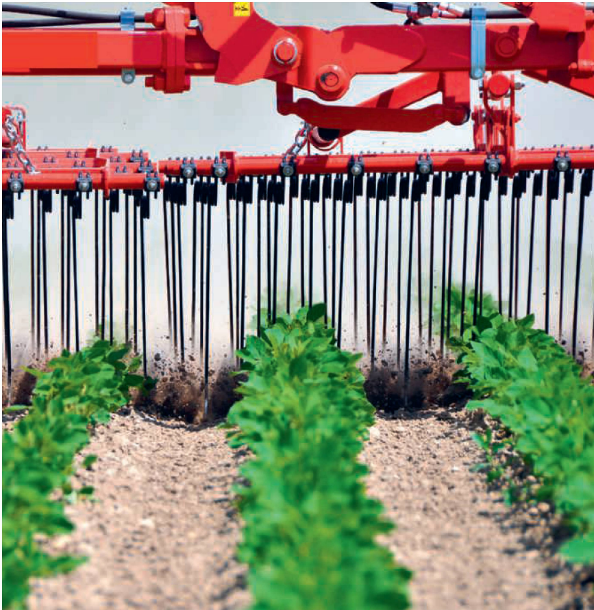
Die Striegelwirkung besteht zu 70% im Verschütten und zu 30% im Ausreissen der Unkräuter. Bild: zvg
