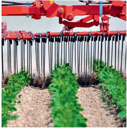
Die Striegelwirkung besteht zu 70% im Verschütten und zu 30% im Ausreissen der Unkräuter. Bild: zvq
