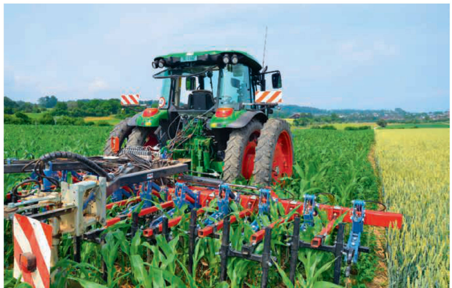
Um einer möglichen Spätverunkrautung Herr zu werden, werden Scharhackgeräte bevorzugt. Bild: R. Hunger
