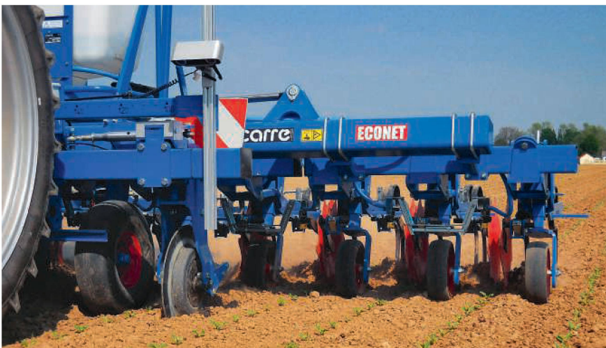
Die Kamera liefert Bilder zur exakten Geräteführung entlang der Pflanzreihen. Bild: Carré
