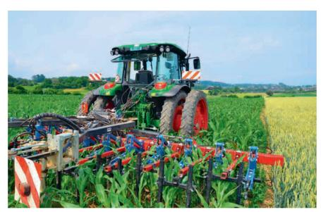
Um einer möglichen Spätverunkrautung Herr zu werden, werden Scharhackgeräte bevorzugt. Bild: R. Hunger
