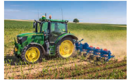
GPS-Gerätesteuerung mithilfe hydraulischer Seitenstreben an den Unterlenkern.
