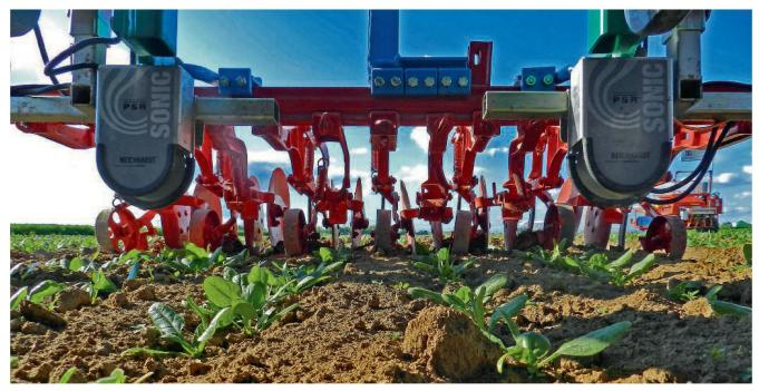
Lenken mit Ultraschall. Als Leitlinie dienen Fahrgassen, Dammkanten oder Pflanzreihen. Bild: Reichhardt
