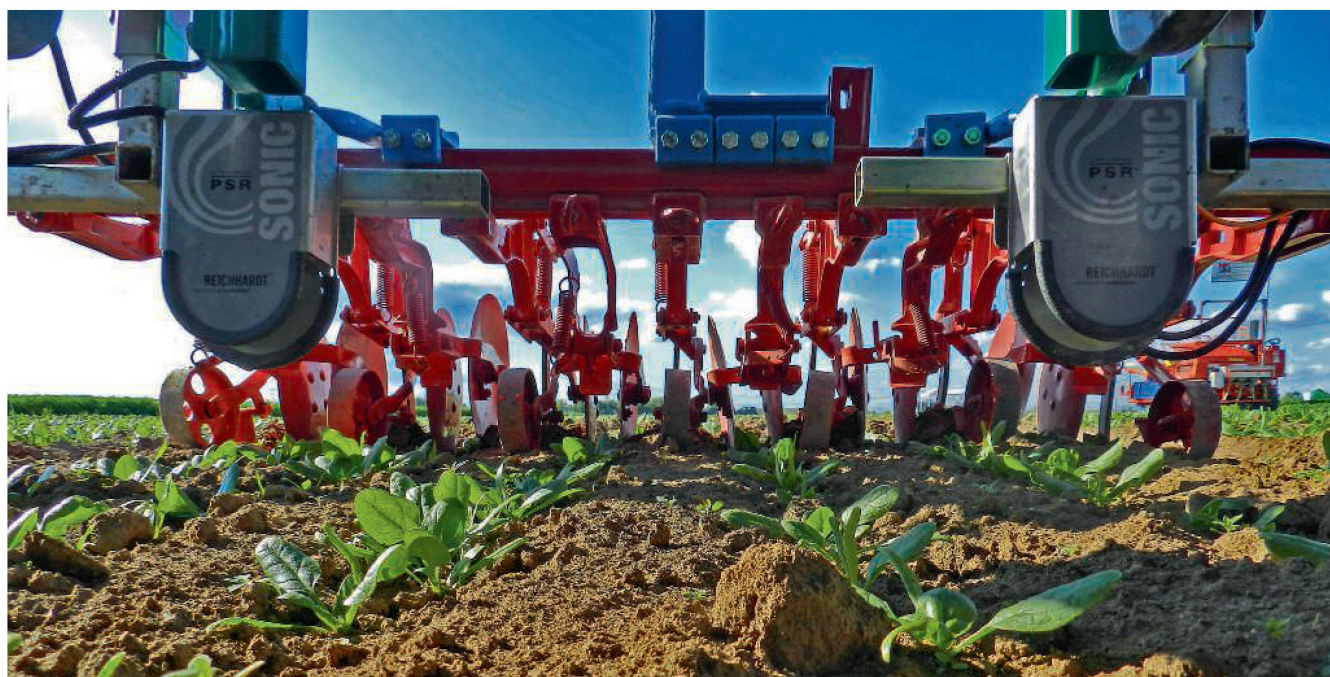
Lenken mit Ultraschall. Als Leitlinie dienen Fahrgassen, Dammkanten oder Pflanzreihen. Bild: Reichardt
