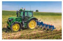
GPS-Gerätesteuerung mithilfe hydraulischer Seitenstreben an den Unterlenkern. Bild: John Deere
