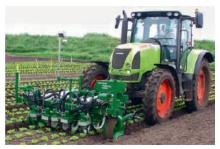
Automatisierte Unkrautregulierung ist insbesondere für den Gemüsebau interessant. Bild: Garford
