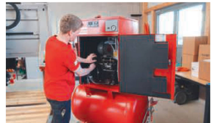
Auch der ölfreie Luftkompressor wird als wichtige Roboter-Komponente revidiert.
