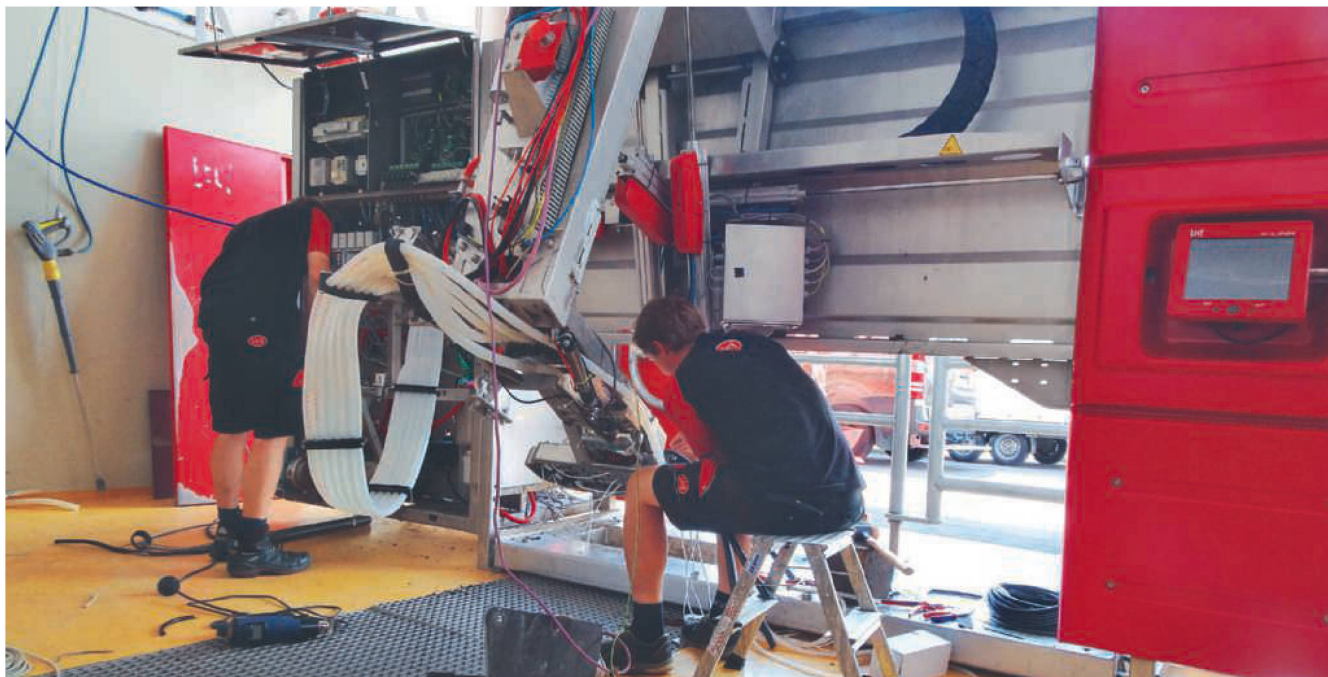
Im Lely Center Härkingen wird ein Melkroboter des Typs «Astronaut A3» auf den neusten Stand nachgerüstet. Der Melkroboter hatte seinen Erstsinsatz in Deutschland. Bilder: zvg/ H. Röthlisberger
