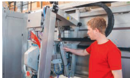
Sämtliche Luftzylinder werden neu abgedichtet und auf ihre Dichtheit geprüft.
