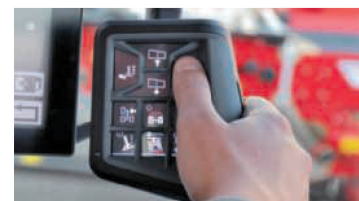
Revolutionär einfache Bedienung dank Touchdisplay sowie Akustik- und Vibrationsfeedback: Joystick «CCI A3».
