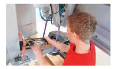
Alle Pulsationskomponenten werden ersetzt und geprüft.
