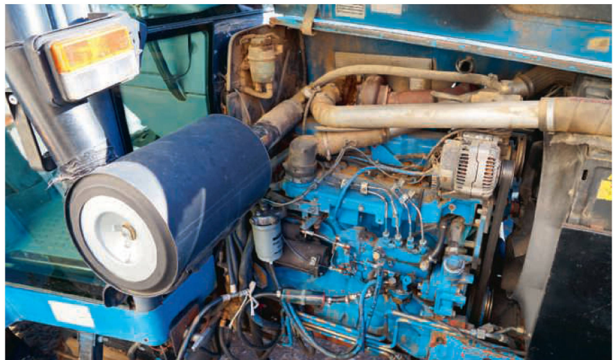
Neben dem nachträglich angebauten «Freiluft»-Luftfilter die mechanische Reihen-Einspritzpumpe von Bosch, darüber die Zuleitungen zum Turbolader.
