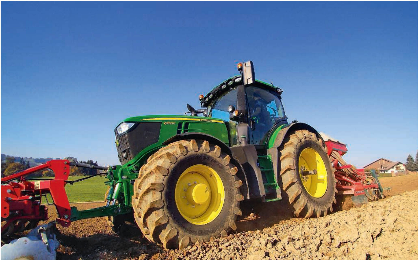
Ein Traktor sollte so leicht wie möglich sein, aber auch so schwer wie nötig, damit die vorhandene Zugkraft bei geringem Schlupf auf den Boden übertragen werden kann. Bild: R. Engeler
