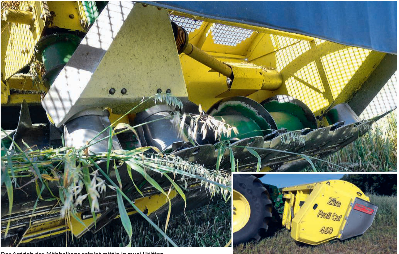
Der Antrieb des Mähbalkens erfolgt mittig in zwei Hälften.
