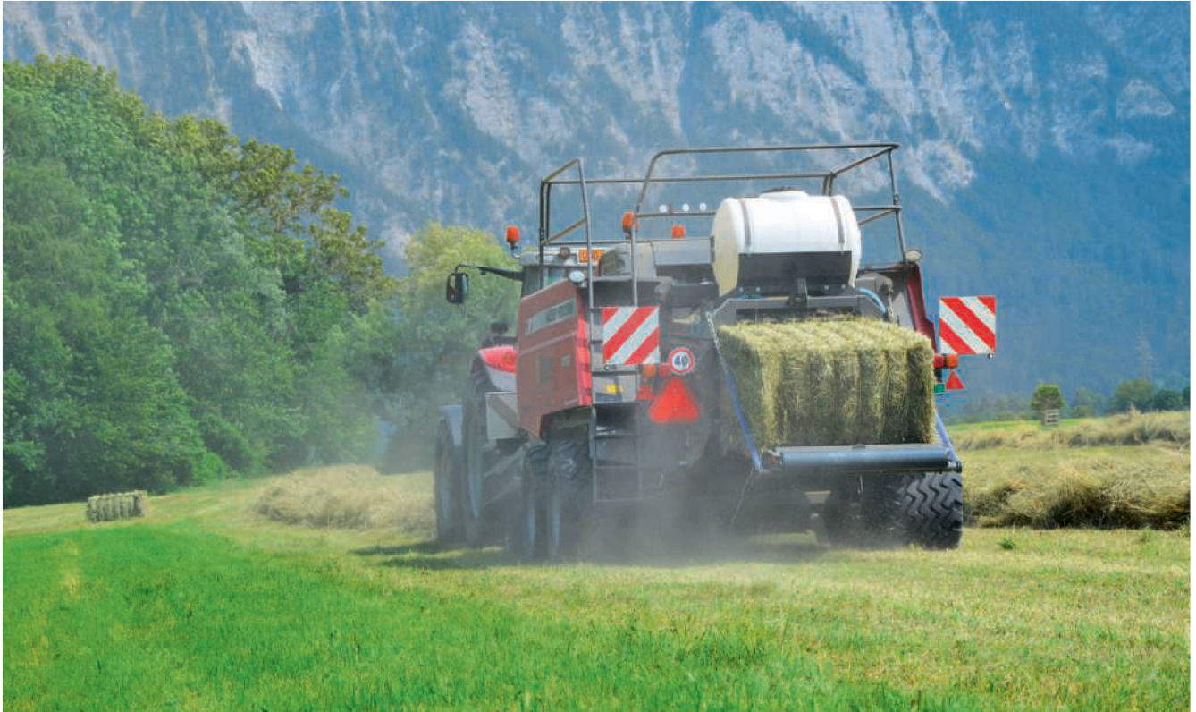
Der Zusatztank auf dem Presskanal enthält premium gepufferte Propionsäure mit einem pH-Wert von 6,0. Bilder: R. Hunger
