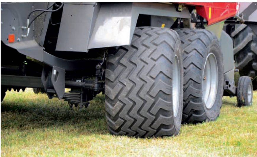
Das Fahrwerk mit Lenkachse reduziert die Grasnarbenschäden.
