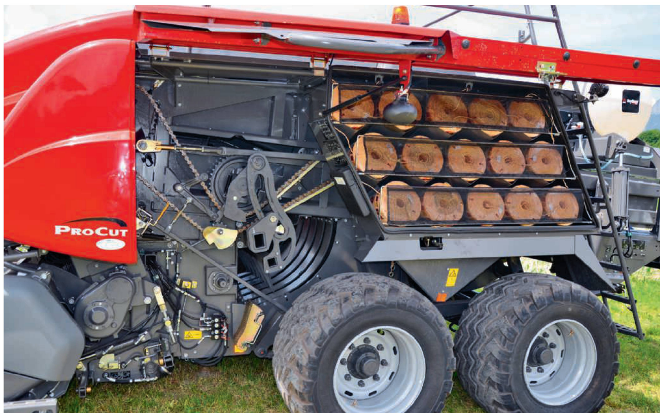
Die Presse verfügt über eine Vorpresskammer, die zu hoher Ballendichte und perfekter Ballenform beiträgt.
