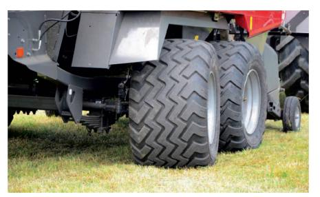
Das Fahrwerk mit Lenkachse reduziert die Grasnarbenschäden.
