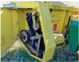
Der seitliche Riemenantrieb ist mit einer Rutschkupplung abgesichert.
