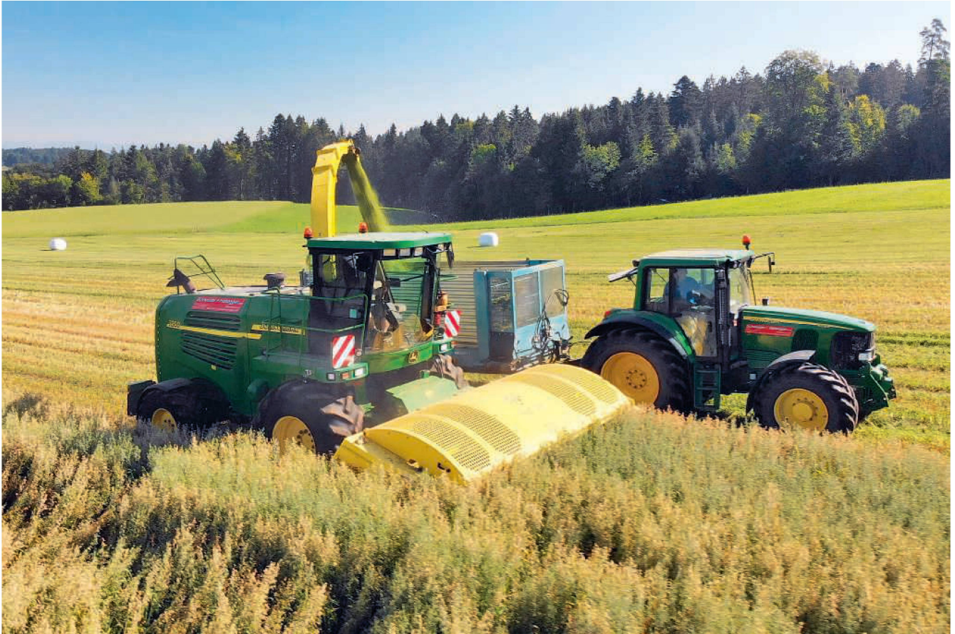
Bei der Ernte mit Direktschneidwerk treten kaum Futtermittelverschmutzungen auf. Bilder: R. Burkhalter
