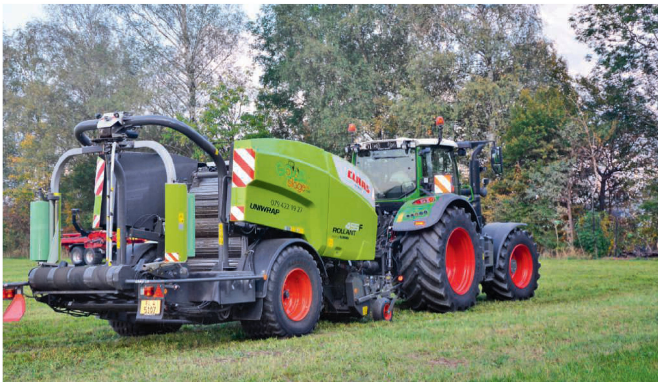
Die Lebenserwartung moderner Pressen liegt bei über 25000 Ballen. Bild: R. Hunger
