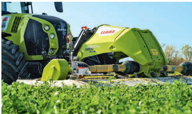
Bei angebauten Frontmähwerken gilt es, den vorderen Überhang, die Achslasten und die Tragfähigkeit der Reifen zu beachten. Bei schweren Modellen (vor allem in Kombination mit einem Aufbereiter) ist man damit oft grenzwertig unterwegs.
