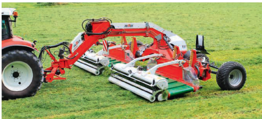
Die neue Bandschwader-Generation kommt mit ausgefeilter Technik daher und ist in Sachen Leistungsfähigkeit breiteren Kreiselschwadern ebenbürtig, bringt weniger verschmutztes Futter zum Schwad, ist aber auch wesentlich teurer.
