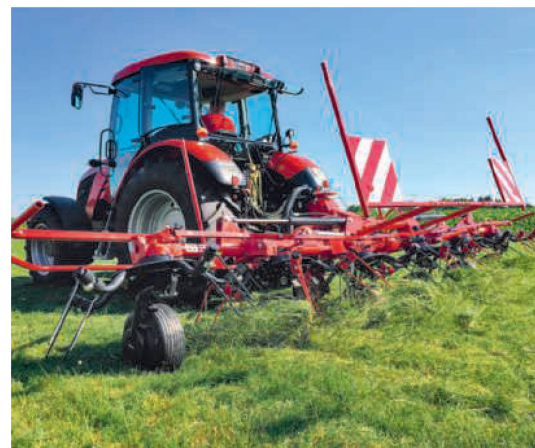
Die restlose und saubere Aufnahme des Futters beim Zetten hängt auch von der richtigen Einstellung des Streuwinkels ab, der wiederum Wurfhöhe und Wurfweite beeinflusst.
