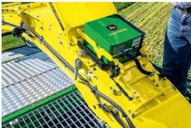
Der Feldhäcksler entwickelt sich zum fahrenden Labor, können doch neben der Feuchte auch Inhaltsstoffe während des Ernteprozesses erfasst werden.
