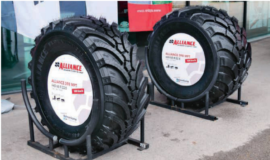
Der Agro-Truck-Reifen «398 MPT» kann auf der Strasse mit bis zu 100 km/h gefahren werden. Für Arbeiten im Feld lässt sich der Reifeninnendruck auf 0,8 bar absenken. H. Röthlisberger
