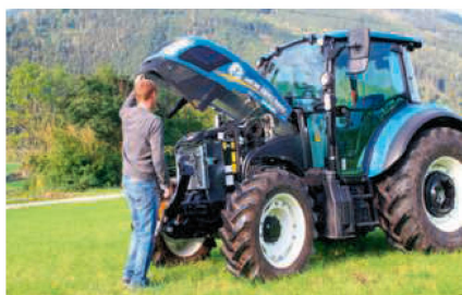
Die 4-Zylinder-FPT-Motoren (Lindner, New Holland, MF) haben alle EGR, DOC und DPF.
