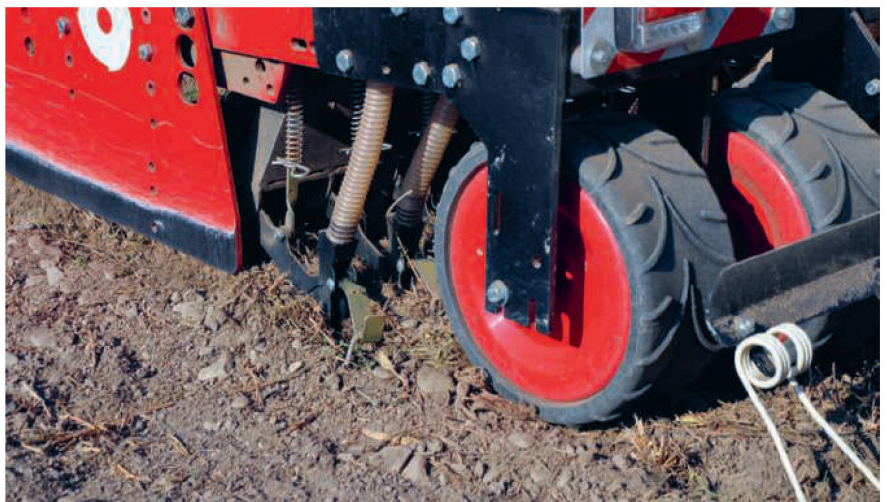
Die eigentliche Sätechnik besteht aus Messerschar, Pneupacker und Saatstriegel.
