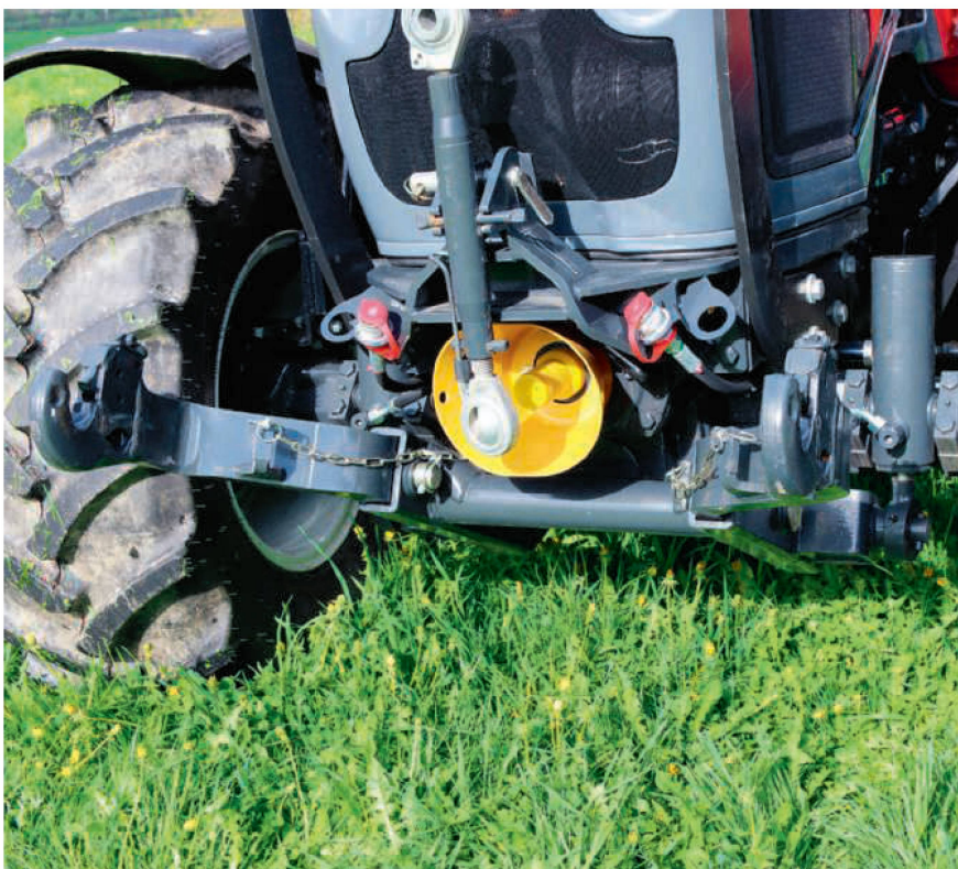
Der Lindner «Geotrac» punktete beim Mähen und Mulchen mit der elektronischen Geräteentlastung und seiner achsgeführten Fronthydraulik.
