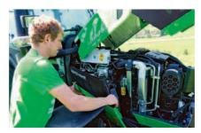
Nur der 3-Zylinder-Deutz-Motor erfüllt die Abgasstufe 3b ohne Dieselpartikelfilter.
