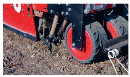
Die eigentliche Sätechnik besteht aus Messerschar, Pneupacker und Saatstriegel.
