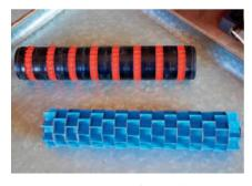
Die Saatgutdosierung erfolgt, abhängig von Saatgutgrösse und Saatmenge mit unterschiedlichen Dosierwalzen.
