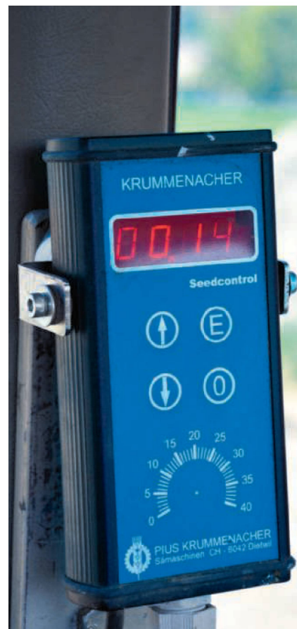
Mit «Seedcontrol» wird die Sätechnik von Krummenacher überwacht. Bild: Ruedi Hunger
