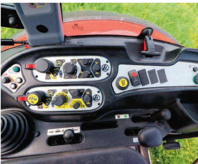
... bietet Lindner wie alle anderen Testkandidaten eine elektronische Hubwerksregelung.
