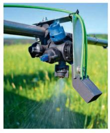
Die Radarüberwachung «SprayMon» von MSO kostet pro Sensor rund 130 Euro. Zielanwendung ist die Nachrüstung an bestehende Pflanzenschutzgeräte.
