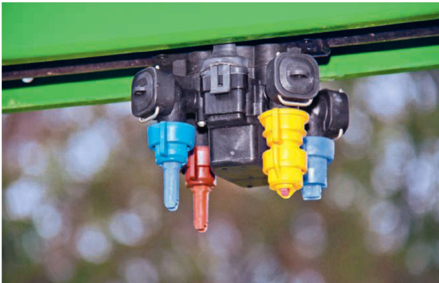
Je komplexer das Düsensystem, desto weniger Fremdstoffe dürfen in der Spritzbrühe sein.
