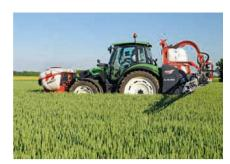
Kuhn ist bisher der einzige Hersteller, der ein Parallelogram an einer Dreipunkt-Feldspritze realisiert hat.
