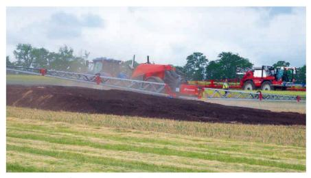
Beim Konturfahren fährt das Fahrzeug auf der Ebene, auf der linken Seite muss das Gestänge über einen ansteigenden Erdhügel geführt werden.
