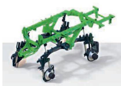
Beim Selbstfahrer «Pantera» von Amazone werden Schläge durch das Tandem-Fahrwerk stark abgeschwächt.
