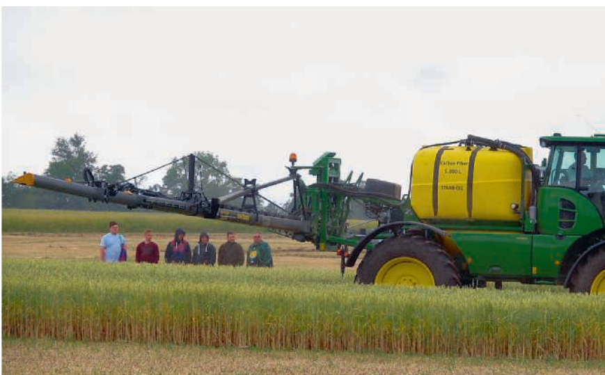
John Deere ist bisher der einzige Hersteller mit einem ultraleichten Gestänge aus Carbon. Leicht bedeutet aber nicht immer auch automatisch stabil.
