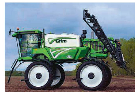
Um die Baulänge zu reduzieren, platziert Grim bei den Selbstfahrern den Motor zwischen den Lenkern des Parallelogramms.
