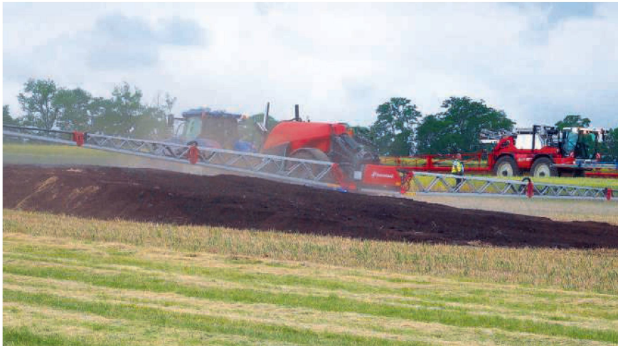
Beim Konturfahren fährt das Fahrzeug auf der Ebene, auf der linken Seite muss das Gestänge über einen ansteigenden Erdhügel geführt werden.
