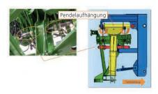
«Swing Stop» von Amazone ist die erste aktive Schwingungsdämpfung für Gestänge. Auf jeder Seite wirken zwei Hydraulikzylinder der Schwingung entgegen.
