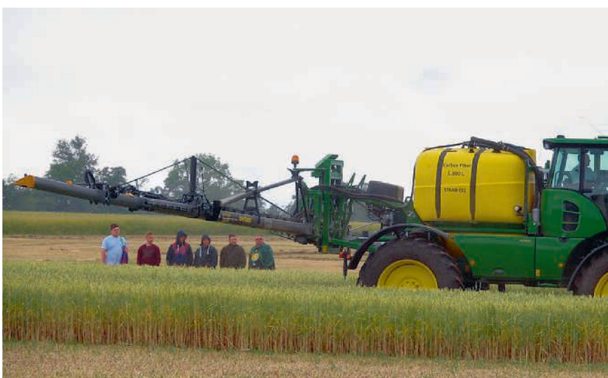
John Deere ist bisher der einzige Hersteller mit einem ultraleichten Gestänge aus Carbon. Leicht bedeutet aber nicht immer auch automatisch stabil.
