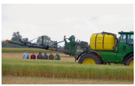
John Deere ist bisher der einzige Hersteller mit einem ultraleichten Gestänge aus Karbon. Leicht bedeutet aber nicht immer auch automatisch stabil.
