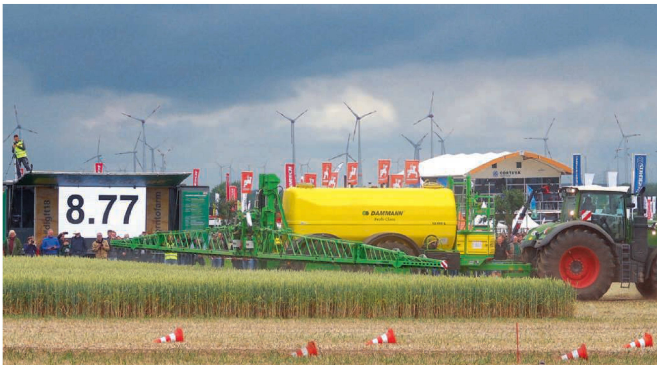
Anspruchsvolle Aufgabe: Spritzgestänge müssen Schläge absorbieren, Neigungsänderungen ausgleichen und zudem das Auftreten von Schwingungen verhindern. Bilder: R.Burkhalter/zvg
