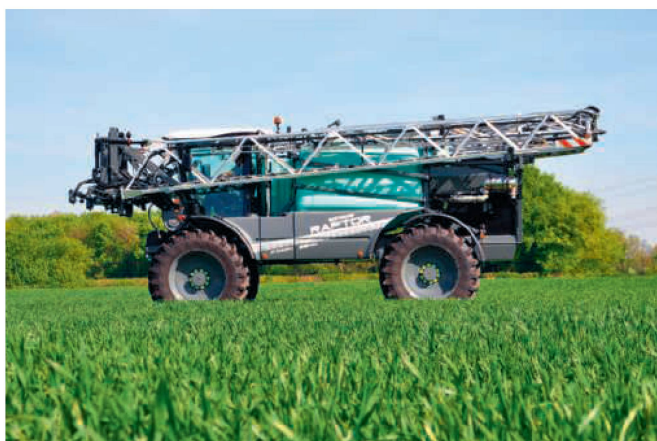
Nicht alle Selbstfahrer haben das gleiche Bauprinzip. Hier ein Spritzgestänge, das an der Fahrzeugfront montiert ist. Bild: Berthoud
