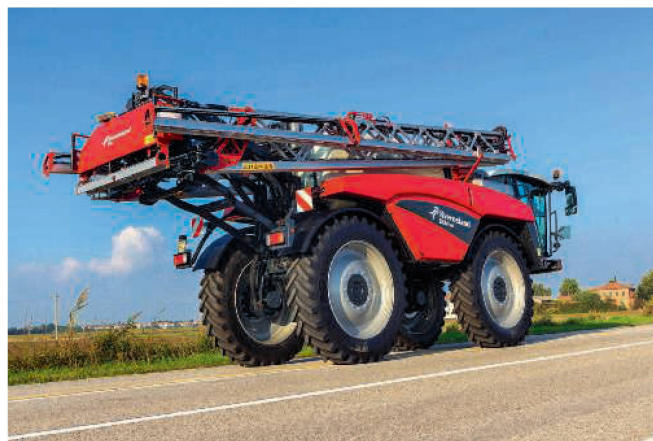
Selbstfahrende Spritzen wie die «iXdrive» haben Volumen zwischen 4000 und 6000 Liter und Arbeitsbreiten bis 40 Meter. Bild: Kverneland
