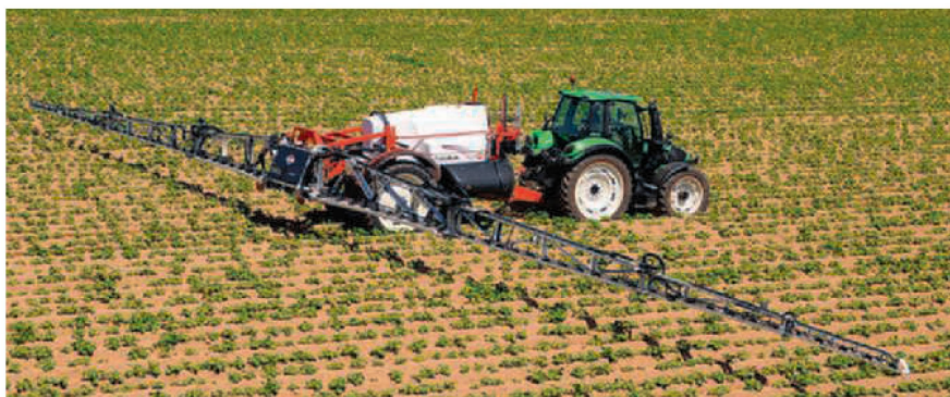
Das Aluminium-Gestänge gibt es für Arbeitsbreiten von 18 bis 36 m.
