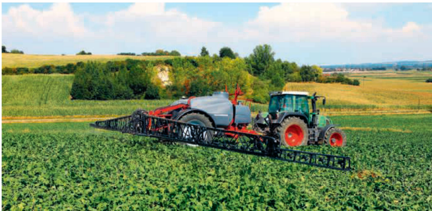
Die Gestängesteuerung «BoomControl» sorgt für konstant gleichbleibende Distanz zwischen Düse und Zielfläche.
