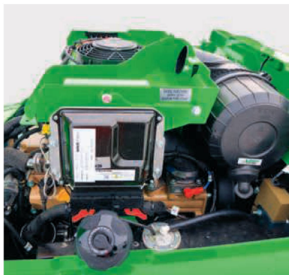
Im Topmodell «860i» arbeitet ein 57 PS starker Kohler-Motor, der die Abgasstufe 5 einhält.
