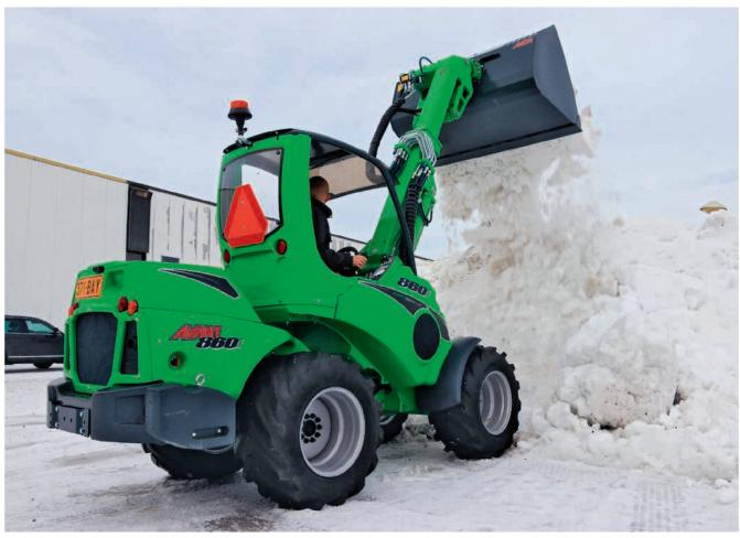
Die neue Serie «800» von Avant erreicht eine Hubkraft von 1900 kg bei einer Hubhöhe von 3,5 m. Bilder: Lukas Weninger
