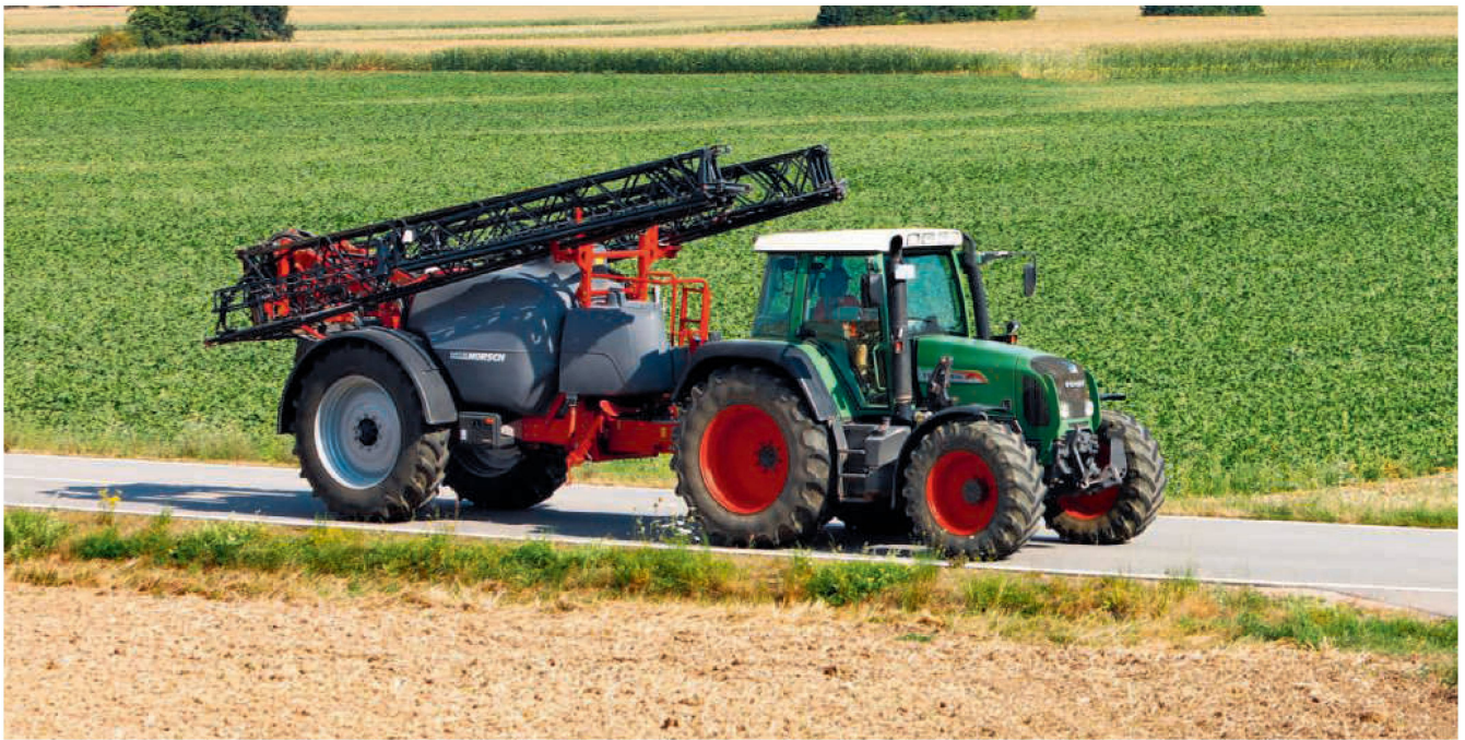
Die «Leeb 4 AX» mit Spritzgestänge zwischen 18 und 30 m ist auch für Schweizer Verhältnisse geeignet. Bilder: Horsch
