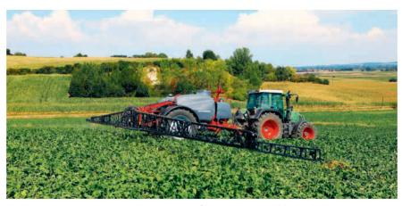
Die Gestängesteuerung «BoomControl» sorgt für konstant gleichbleibende Distanz zwischen Düse und Zielfläche.
