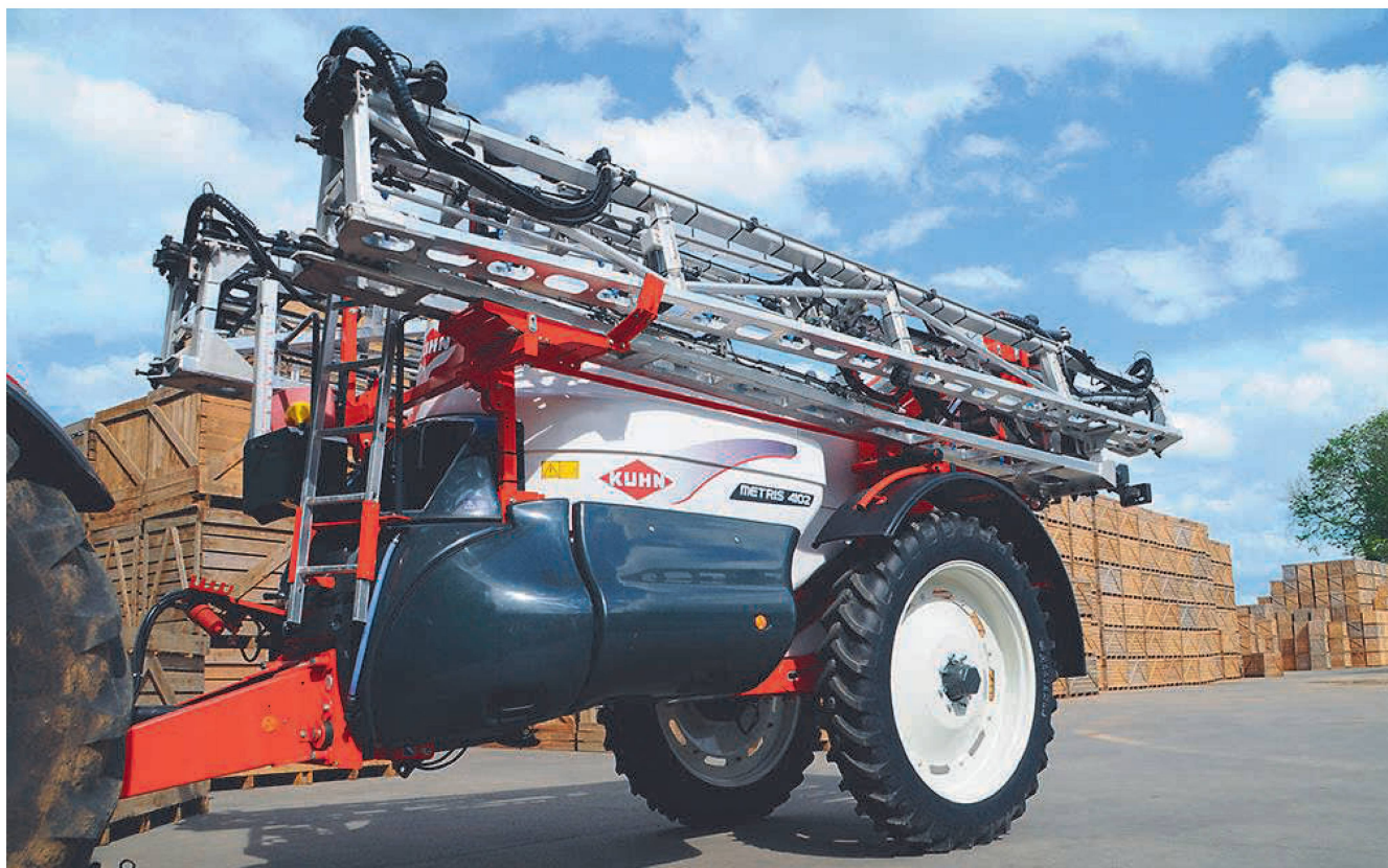
Hohe Applikationsgenauigkeit mittels Pulsweitenmodellierung und kompakte Bauweise zeichnen die neue «Metris 2» von Kuhn aus.
