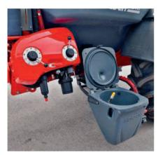
Bedieneinheit und Einspülschleuse. Zwei Mehrweghähne reichen aus, um die «4 AX» zu bedienen.
