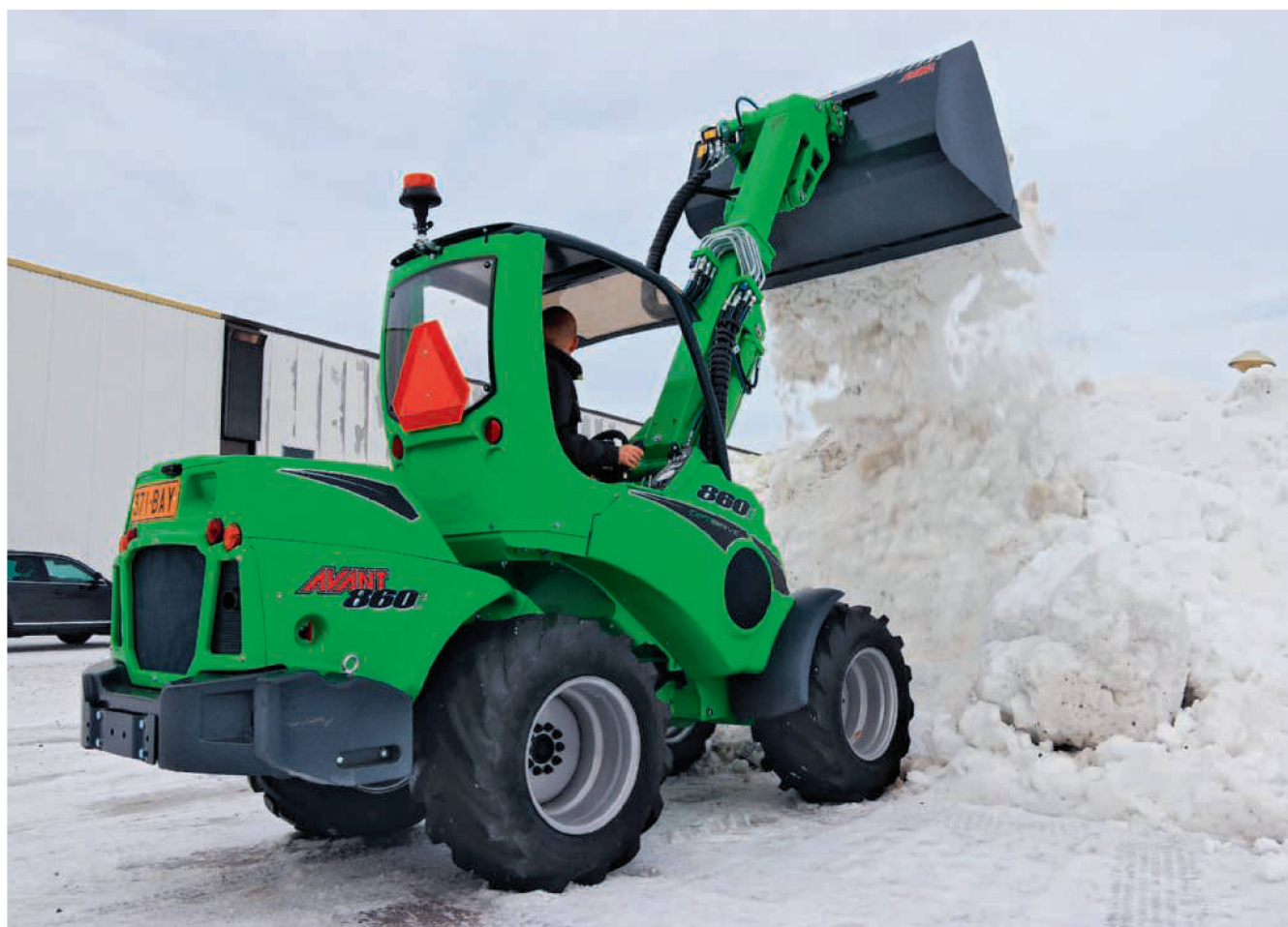
Die neue Serie «800» von Avant erreicht eine Hubkraft von 1900 kg bei einer Hubhöhe von 3,5 m. Bilder: Lukas Weninger
