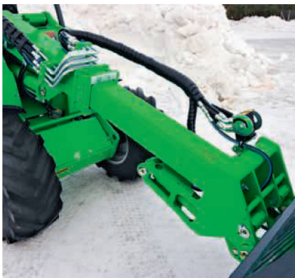
Der Teleskoparm ist nun stärker dimensioniert. Darunter sitzen zwei (statt bisher einem) Kippzylinder für das Werkzeug.
