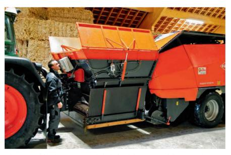
In kürzester Zeit bereit zum Pressen: Mit der hydraulischen Steuereinheit vorne an der Presse bringt Marcel Villiger die Dosiereinheit mit Trichter wie auch die Rutsche und deren Seitenwände in Position.
