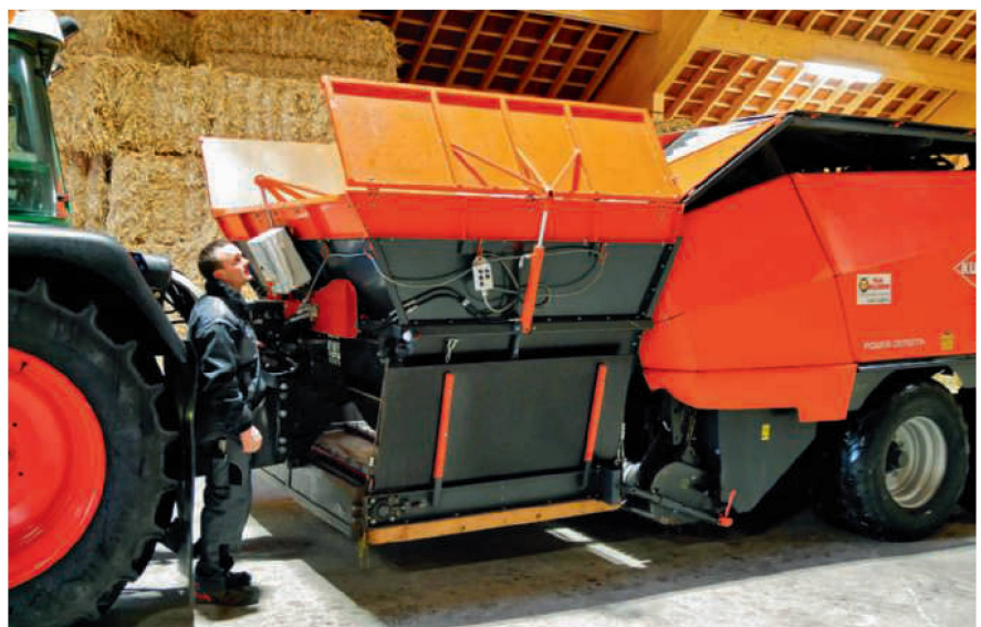
In kürzester Zeit bereit zum Pressen: Mit der hydraulischen Steuereinheit vorne an der Presse bringt Marcel Villiger die Dosiereinheit mit Trichter wie auch die Rutsche und deren Seitenwände in Position.
