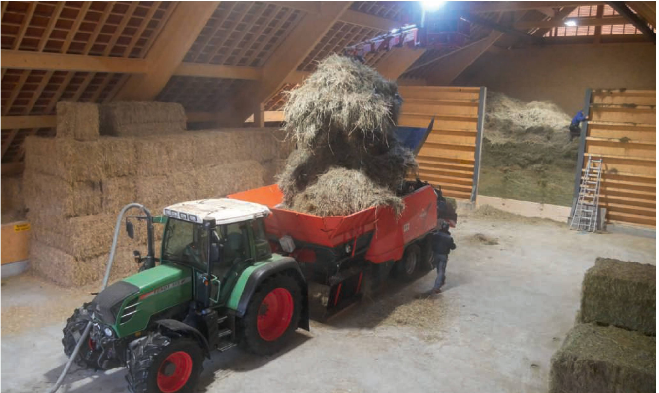
Die auf Heu-ab-Stock-Pressen umgebaute Kuhn-Quaderballenpresse «LSB 1270» in der Scheune des Gutsbetriebs Chamau. Ein Schlauch am Auspuff leitet das Abgas nach draussen und verhindert auch einen Funkenflug. Bilder: H. Röthlisberger
