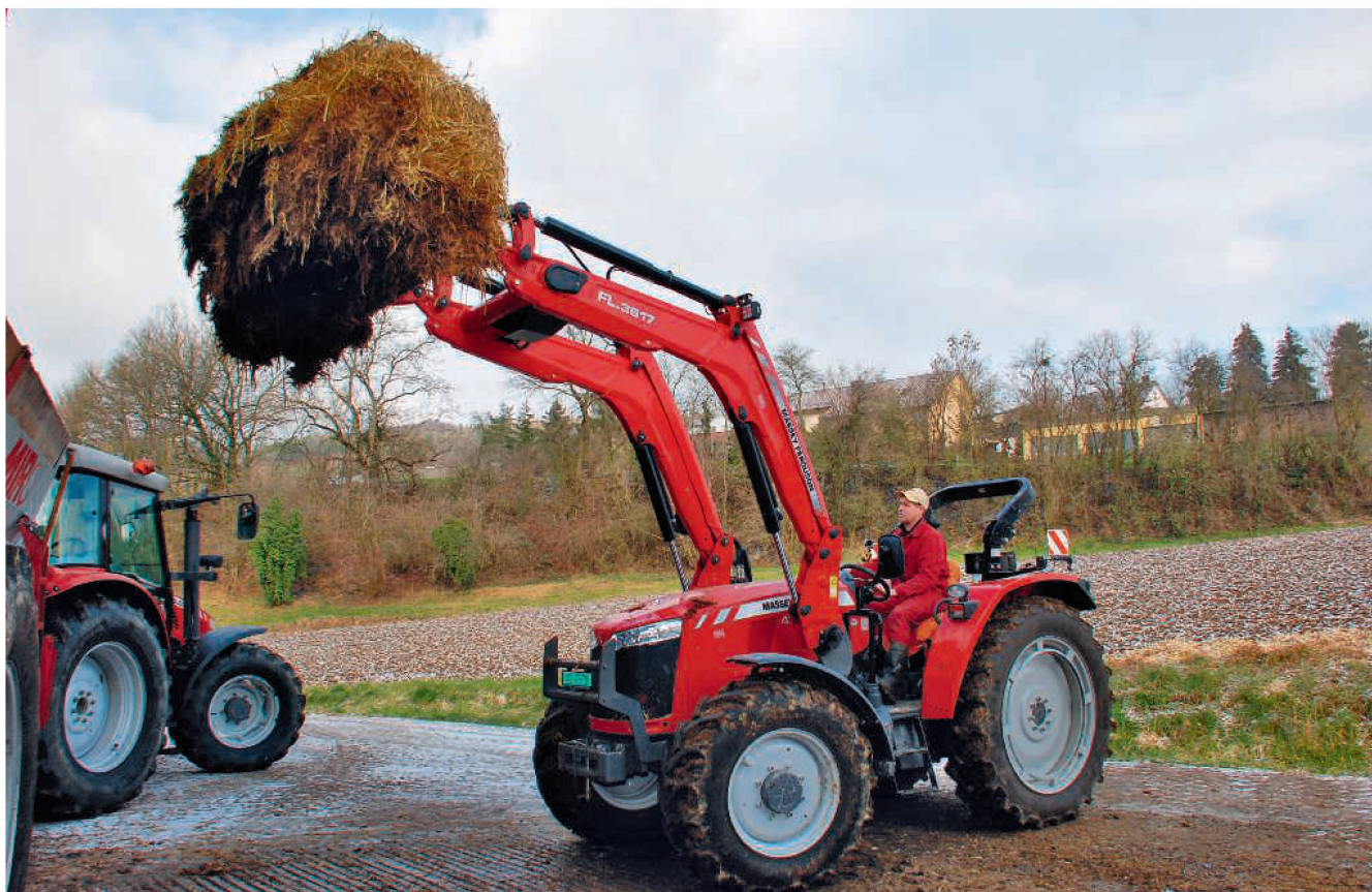
Der «4709 Global» stemmt hinten 3000 kg, auch für den Frontlader-Betrieb reicht die Tragfähigkeit aus. Bilder: R. Burkhalter, H. Röthlisberger
