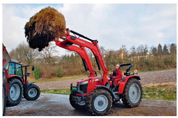
Der «4709 Global» stemmt hinten 3000 kg, auch für den Frontlader-Betrieb reicht die Tragfähigkeit aus. Bilder: R. Burkhalter, H. Röthlisberger
