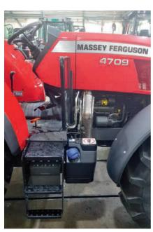
Das «All-in-one»-Abgasreinigungssystem mit AdBlue-Tank.
