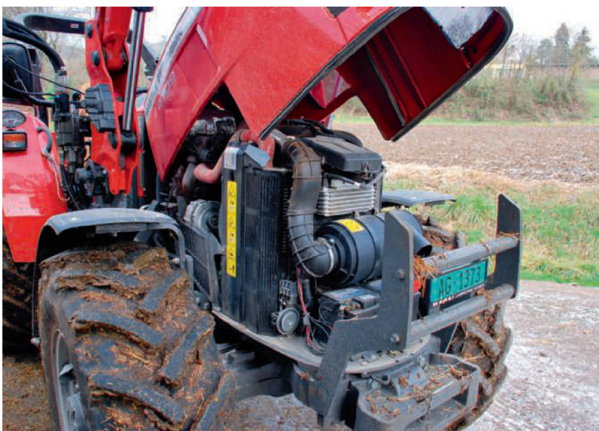
Die Wartungspunkte des Motors sind gut zugänglich. Das Kühlerpaket wird durch ein herausziehbares Gitter vor Verschmutzung geschützt.
