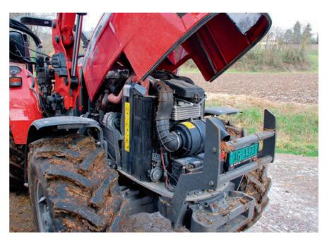
Die Wartungspunkte des Motors sind gut zugänglich. Das Kühlerpaket wird durch ein herausziehbares Gitter vor Verschmutzung geschützt.
