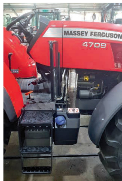
Das «All-in-one»-Abgasreinigungssystem mit AdBlue-Tank.
