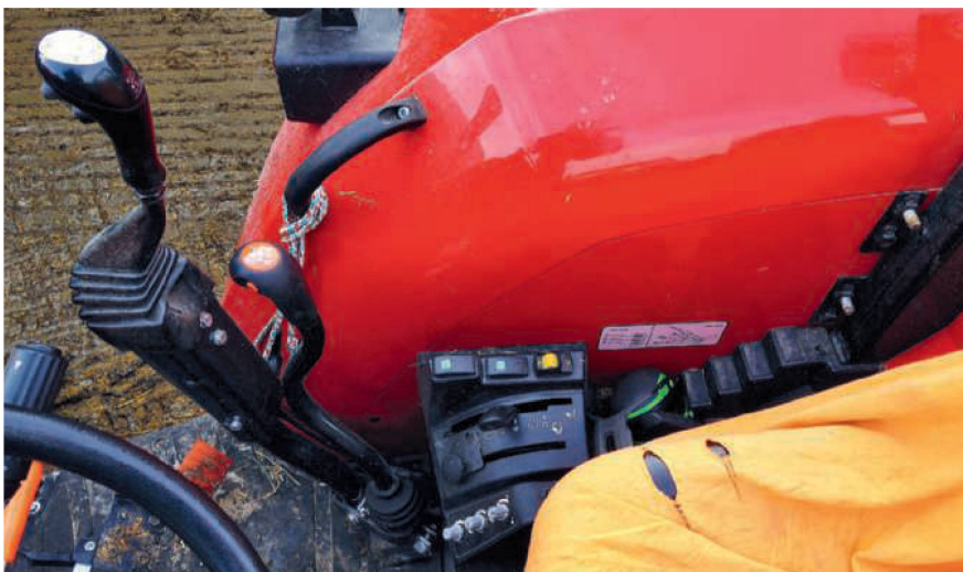
Viele Bedienungselemente wie die EHR-Drehregler sind rechts vom Fahrersitz untergebracht.
