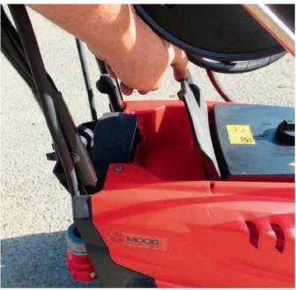
Das Schnellkuppelsystem mit kurzen und eher gering dimensionierten Steckkupplungen funktionierte im Test.
