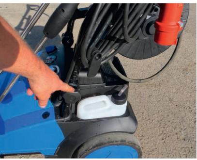
Für die Beimischung von Reinigungsmitteln stehen zwei separate Tanks bereit, die kompakt ins Gerät integriert sind.
