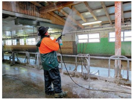
Spezielle Lanzen mischen vor dem Sprühkopf zusätzlich viel Luft dazu, so dass eine grosse Menge an zähfliessendem Schaum entsteht.
