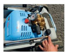
Auf der ausserhalb der Verschalung montierten Pumpe ist ein Druckregler vorhanden.
