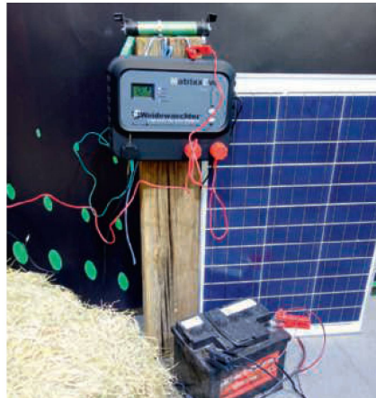
Das «MatrixxEvo» von Weidewächter ist eines der günstigsten Geräte, das eine Echtzeit-Überwachung mit Bedienfunktionen über das Smartphone und zusätzlich eine «Geo-Fencing»-Funktion bietet.
