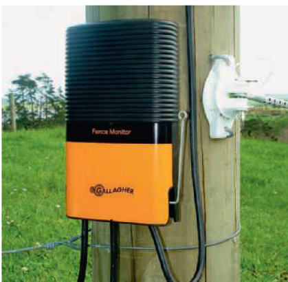
Für die Überwachung von Teilabschnitten des Zauns können bis zu sechs dieser externen Zaun-Monitore an einem «i»-Gerät von Gallagher angeschlossen werden.
