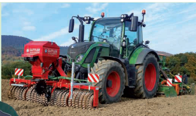
Im Ackerbau kommt die Güttler-Walze als Frontpacker mit der Säkombination zum Einsatz
