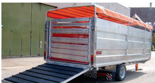
Heckabschlussgitter: Macht in diesem Fall Sinn, nicht aber unbedingt bei Viehwagen mit absenkbarer Ladefläche. Bild: zVg
