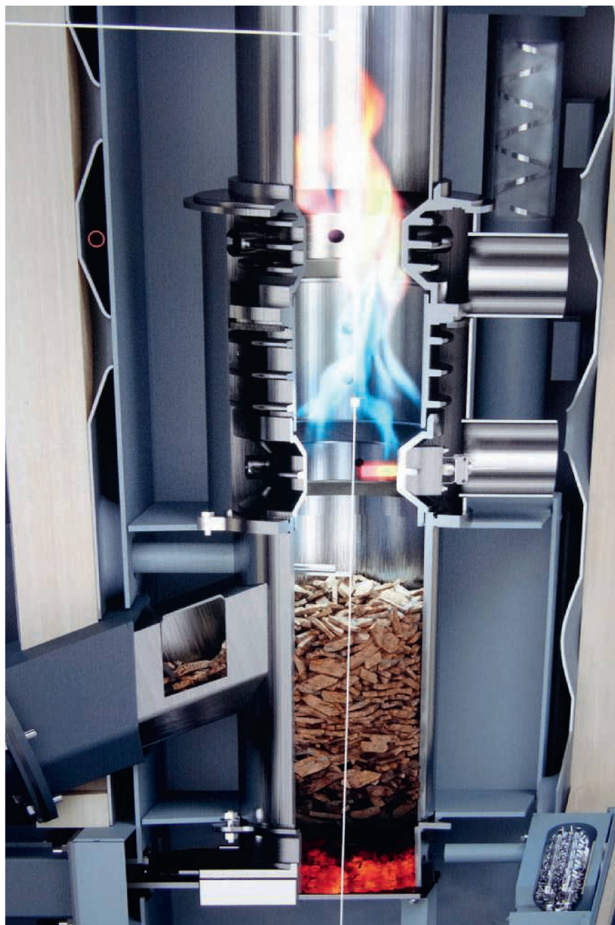
Die «PuroWin»-Feuerung von Windhager hat keinen Filter. Mit Hilfe einer patentierten Gegenstromvergasung macht man sich die filternde Wirkung des Brennstoffvorrates im Kessel zunutze. Bilder: C. Brüggemann
