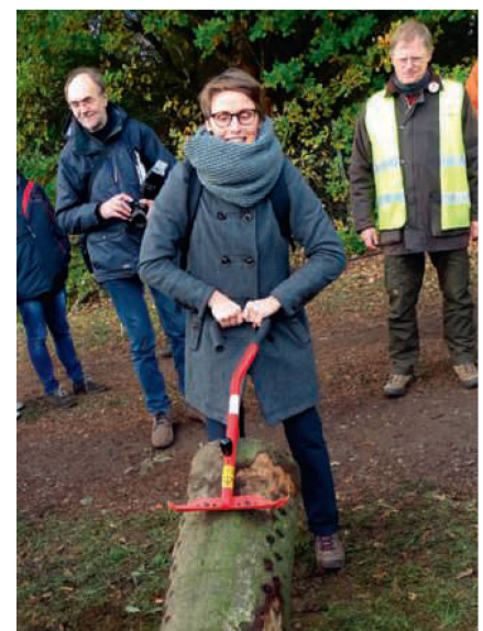
Das patentierte Werkzeug «HolzUp» reduziert dank Hebelwirkung den Kraftaufwand beim Aufarbeiten von Brennholz.
