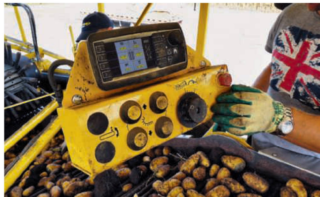
An der «Premium»-Bedienung kann das Verlesepersoneel sämtliche Einstellungen der Maschine selber beeinflussen.
