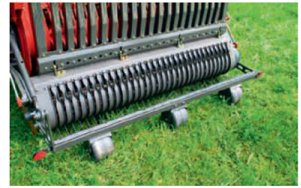
Das 1,90 m breite Pickup mit fünf Zinkenreihen weist einen grossen Pendelweg auf.
