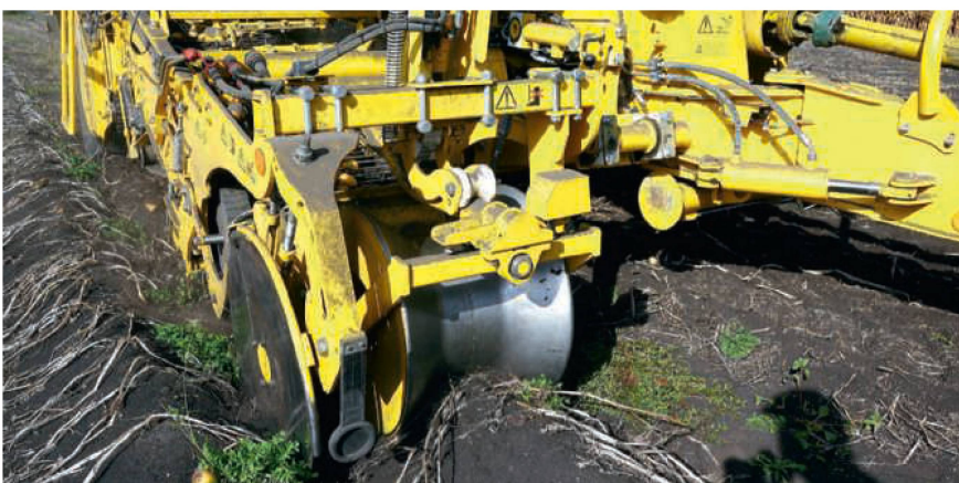
Die Aufnahme ist mit elektronisch gesteuerter Dammtrommellenkung und einer Dammdruckregelung ausgerüstet.
