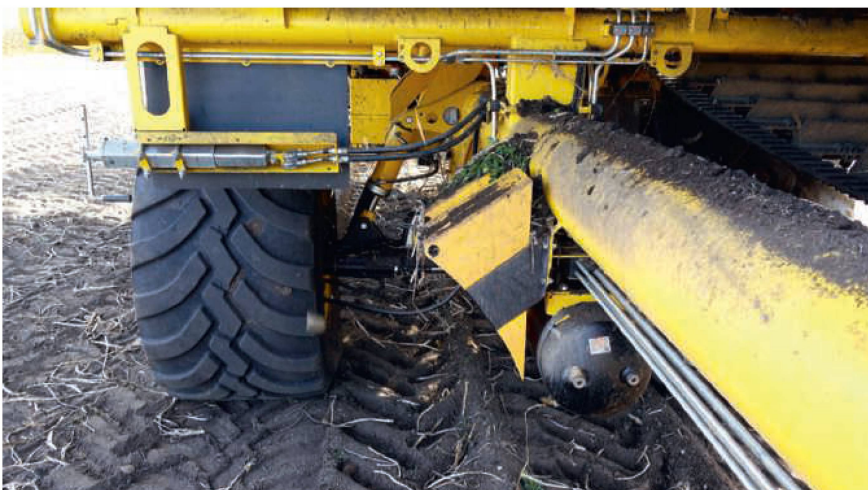
Die Achse ist über einen automatischen, hydraulischen Neigungsausgleich mit dem Zentralrohrrahmen verbunden.
