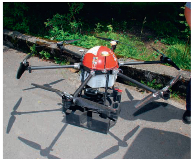
Diese Sprühdrohne von Agrofly hat rund 40 kg Gesamtgewicht und eine Nutzlast von 17 kg. Bild: H. Röthlisberger
