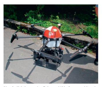
Diese Sprühdrohne von Agrofly hat rund 40 kg Gesamtgewicht und eine Nutzlast von 17 kg. Bild: H. Röthlisberger
