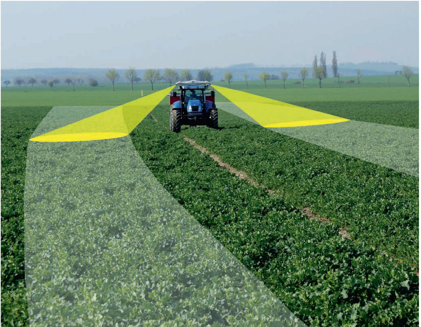
Yara-N-Sensor «ALS» auf dem Kabinendach. Der N-Sensor misst und analysiert das vom Pflanzenbestand reflektierte Sonnenlicht. Bild: Yara
