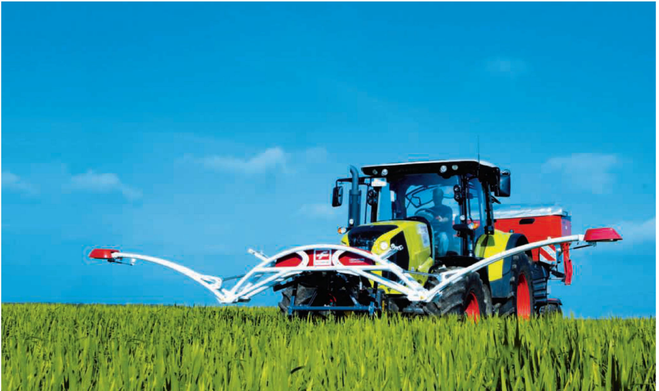
Klassische Sensoranwendung für die qualitätsbetonte Düngung im Getreide. Bild: Claas/Fritzmeier
