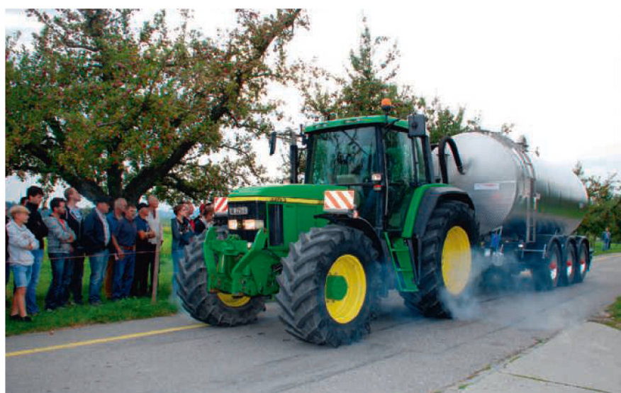
In Ergänzung zu einem Zwei-Leiter-Bremssystem kann bei Traktoren ein hydraulisches Ein-Leiter-Bremssystem aufgebaut werden (im Gegensatz zur geltenden EU-Regelung auch noch nach 2025). Bild: H. Röthlisberger
