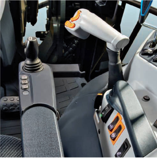
Lastschaltstufen und Gänge können mit den Wippschaltern am grauen Hebel geschaltet werden.
