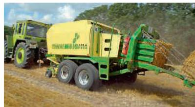
Vor 25 Jahren baute Krone seine erste Grosspackenpresse. Begonnen hat Krone mit den zwei Modellen «Big Pack 80-80» sowie «Big Pack 120-80» (im Bild). 1993 war Krone der erste Hersteller weltweit, der die Ausrüs-tungsvarianten Schneidwerk (3 Messer) und Tandemachse für Grosspackenpressen anbieten konnte. Ebenfalls ein-malig im Markt war die automatisch wieder einrastende Überlastkupplung
