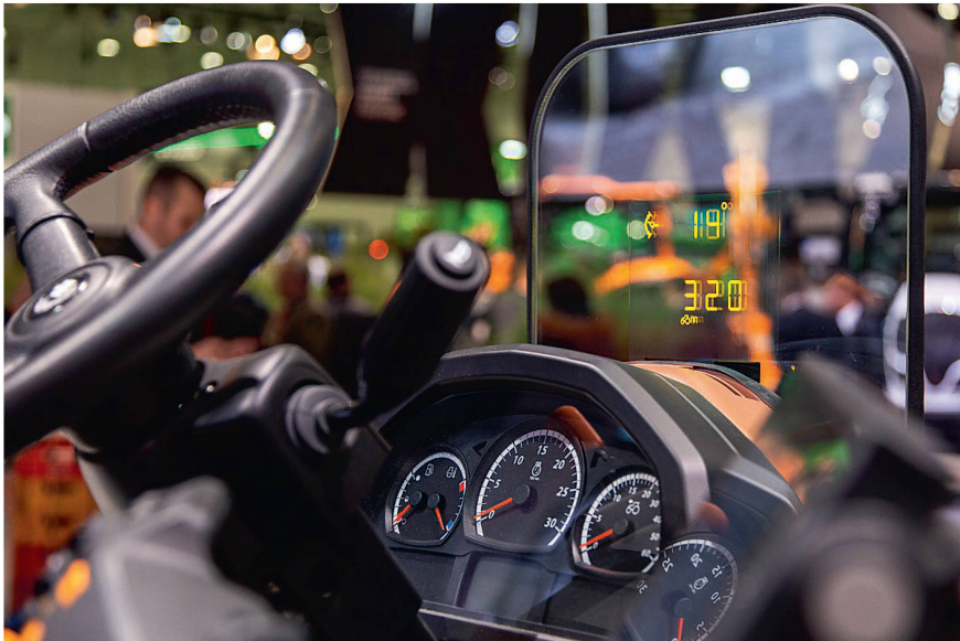
Valtra hat mit «SmartGlass» seit gut zwei Jahren ein «Head-up-Display» in der Entwicklung. Nächstes Jahr geht das Anzeigesystem in ausführliche Tests. Bilder: zvg
