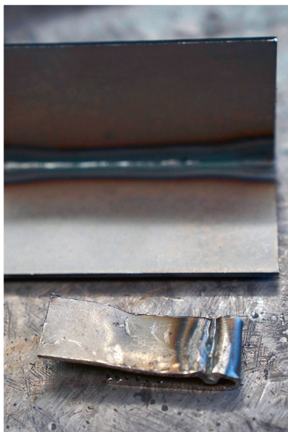
Die Biegeprobe (unten) bei einem Werkstück zeigt: Die Naht hat gehalten.
