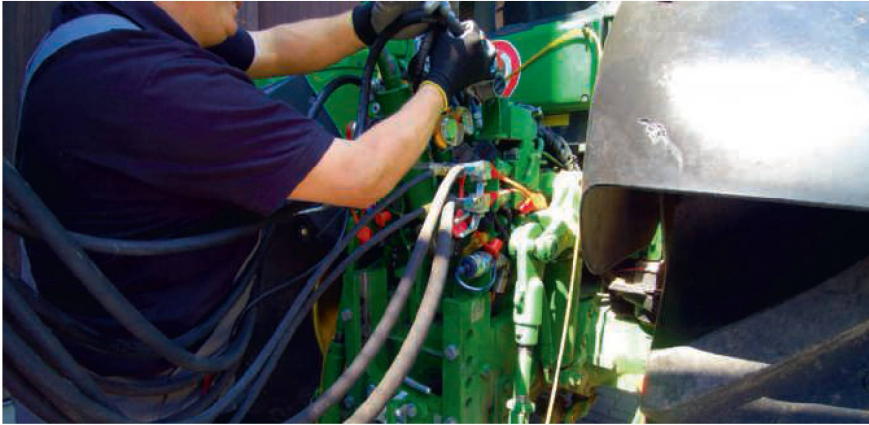
Wer in ein Zweileiter-Bremssystem investiert, sollte auf die pneumatische Variante setzen.
