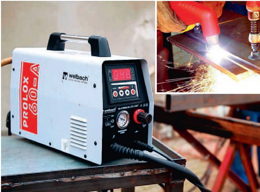
Der Plasmaschneider erzeugt einen elektrischen Lichtbogen. Damit können zahlreiche leitende Materialien wie Metalle und Bleche höchst präzise geschnitten werden. Bilder: zvg
