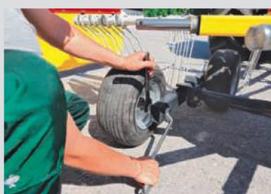
Auf der Schwadseite wird mehr Futter transportiert. Bei schwerem Gras weichen die Zinken etwas nach hinten aus. Das führt zu einem höheren Bodenabstand. Damit kein Futter verloren geht, sollte man die Tasträder auf der Schwadseite etwas tiefer einstellen.
