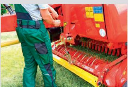
Höheneinstellung der Schwadrolle beziehungsweise des Niederhalters in Abhängigkeit der Futtermenge: Sie unterstützen den Futterfluss. Ist die Schwadrolle bei wenig Futter zu hoch eingestellt, wird dieses nach vorne gewälzt und nicht aufgenommen.
