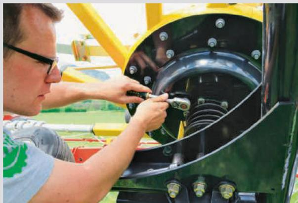
Die Schwadform lässt sich mit der Kurvenbahnverstellung beeinflussen: Sind die Seitenkanten zu flach, verdreht man die Kurvenbahn so, dass die Zinken etwas später aussteuern. Dann wird das Futter weiter in die Schwadmitte transportiert.
