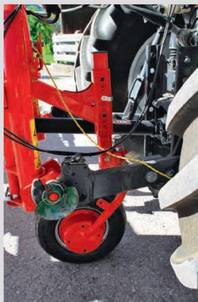
Ist ein Stützrad vorhanden, erfolgt die Tiefeneinstellung über das Tastrad am Anbaubock. In diesem Fall benötigt der Oberlenker einen Freigang. Die Einstellung erfolgt auf ebenem Untergrund.
