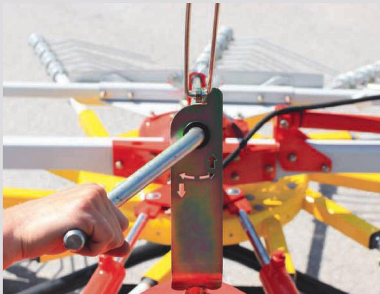
Nach der Grundeinstellung am Stützrad: Der Kreisel wird mit einer Spindel in Fahrtrichtung waagrecht ausgerichtet – Feinjustierung der Höhe über das gesamte Fahrwerk.
