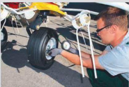
Kontrollarbeiten vor Arbeitsbeginn: feste Zinken, Anstellwinkel, Verlustsicherung und Luftdruck in allen Rädern.
