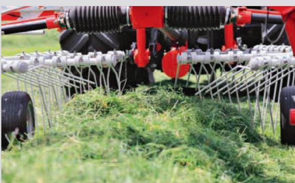
Die Schwabreite ist auf die Arbeitsbreite des Pickups des Folgegerätes abzustimmen. Die Schwadform muss ein Trapez mit steilen Seitenflanken ergeben, damit ein problemloses Überfahren beim Laden möglich ist. Zu flache Flanken werden von den Rädern der Zugmaschine niedergefahren und können von dem Pickup nicht mehr aufgenommen werden.
