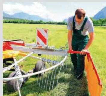
Das Schwadtuch lässt sich in der Breite, in der Höhe und oft auch in Längsrichtung verstellen. Die Schwadbreite muss auf die Futtermenge und auf die Pickup-Breite des Folgegeräts abgestimmt werden.
