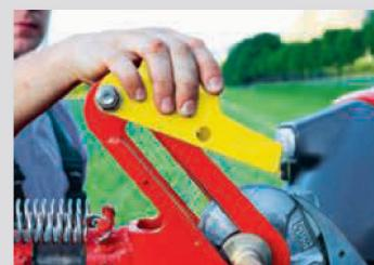
Für den Strassentransport müssen die Nachlaufeinrichtung und der Oberlenker – meist durch Umlegen von Klappen oder Umstecken von Bolzen – wieder stabilisiert werden.
