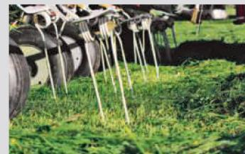
Im Feld muss die Arbeitstiefe in Abhängigkeit der Stoppelhöhe nochmals kontrolliert werden. Richtige Vorgangsweise: Zuerst ein paar Meter fahren, damit sich der Rahmen nach dem Auseinanderklappen ausrichten kann; dann den Zinkenabstand zum Boden kontrollieren. Die Zinken dürfen keinesfalls kratzen.
