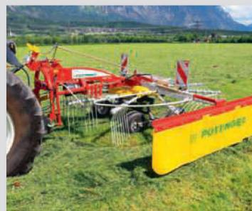
Ein zu tief eingestelltes Schwadtuch verschleisst stärker. Läuft es zu hoch über dem Boden, fällt Futter unten durch und der Schwad franst aus.
