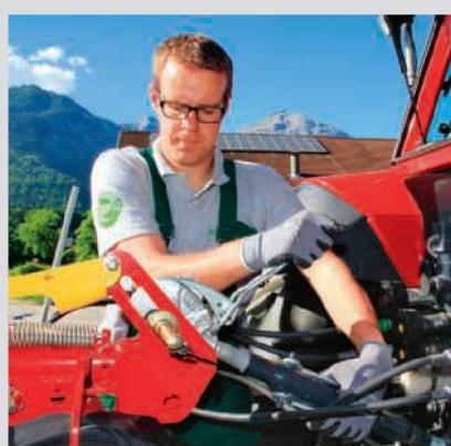
Die Länge muss so gewählt werden, dass sich der Kreisler nach oben und unten frei bewegen kann, also in die Mitte des Langlochs. Ohne Tastrad erfolgt die Tiefeneinstellung durch die Oberlenkerlänge in einem «Fixloch».
