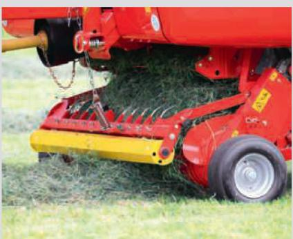
Eine saubere Aufnahme durch das Pickup setzt eine entsprechende Stoppelhöhe und eine gleichmässige, trapezförmige Schwadform mit steilen Flanken voraus. Die richtige Anbauhöhe und die Tiefeneinstellung der Pickup-Zinken minimieren Futterverluste. Eine ausgeklügelte Fahrstrategie mit möglichst weiten Radien schont die Grasnarbe und verhindert das Überfahren des Futters.
