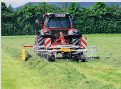
Wie beim Kreiseln müssen auch beim Schwaden die Drehzahl und die Fahrgeschwindigkeit sorgfältig gewählt werden. Die Schwadbreite und die Schwadform bestimmen in hohem Masse die Leistungsfähigkeit der nachfolgenden Erntetechnik. Der Schwad sollte möglichst gerade verlaufen. Enge Kurven müssen vermieden werden, da die Kurvenradien der Folgegeräte deutlich grösser sind, als sie mit einem Schwader möglich wären.
