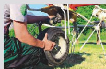
Mit der Streuwinkelverstellung an den Rädern lässt sich das Streubild abhängig von der Futtermenge und dem Trocknungsgrad optimieren. Eventuell muss die Arbeitstiefe nachjustiert werden.
