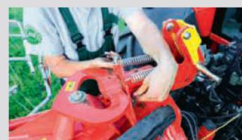
**Nachlaufeinrichtung:** Viele Anbau-Kreisler sind mit einer Nachlaufeinrichtung ausgerüstet. Für den Wechsel von Transport- in Arbeitsstellung muss diese freigegeben werden.
