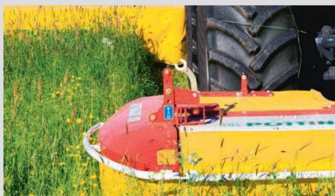
Der Überschnitt (mind. 10–15 cm) bei Heck-/Frontkombinationen muss auf die Spurweite und die Arbeitsbreiten der Mäheinheiten abgestimmt werden. Sonst bleibt schon bei leichten Kurvenfahrten Gras stehen.
