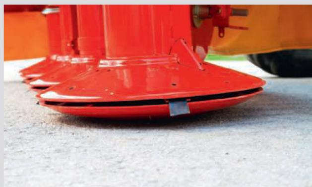
Für einen höheren Schnitt muss der Abstand zwischen Gleitteller und Mähtrömmel vergrössert werden. Dazu bieten die Hersteller Spindelsysteme, Distanzplatten oder spezielle Hochschnitt-Gleitteller an.
