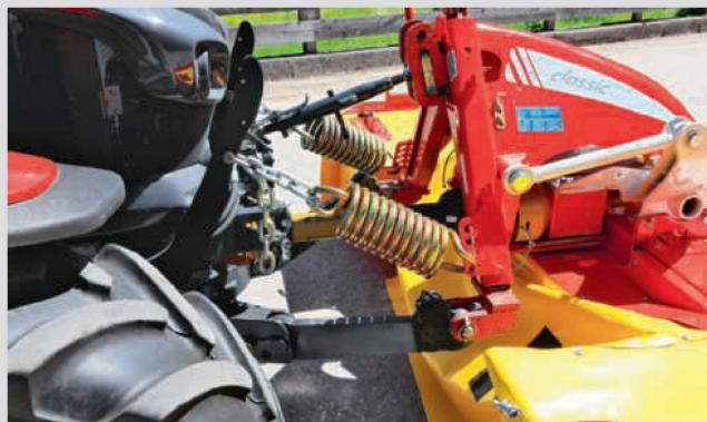
Die Spannung und der Anstellwinkel der Entlastungsfedern beeinflussen die Bodenanpassung erheblich – Herstellerangaben genauestens beachten! Ein geringer Auflagedruck schont die Grasnarbe.
