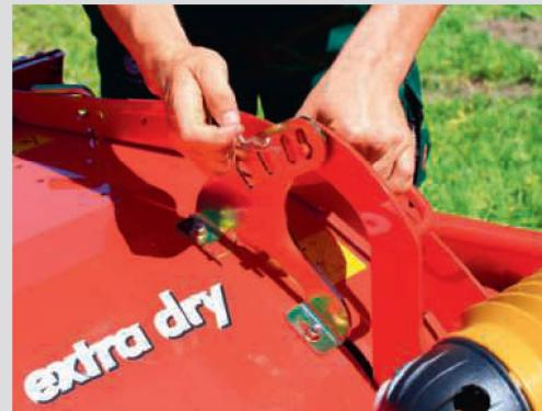
Stufenweise Anpassung an die gewünschte Aufbereiterintensität durch Verengen des Durchgangs.
