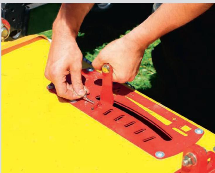
Einstellung der rotierenden Schwadscheiben auf die Spurweite des Traktors.
