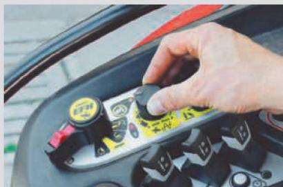
Mit einer elektronischen Hubwerksentlastung kann man den Auflagedruck des Mähbalkens den jeweiligen Bedingungen während der Fahrt anpassen. Zu wenig Gewicht am Balken führt zu Wellenschnitt in Längsrichtung.
