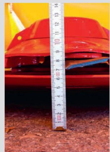
Bei waagrecht eingestelltem Mähbalken beträgt die Schnithöhe etwa 7 cm. Diese kann man durch Verlängern oder Verkürzen des Oberlenkers geringfügig (+/- 2 cm) ändern.
