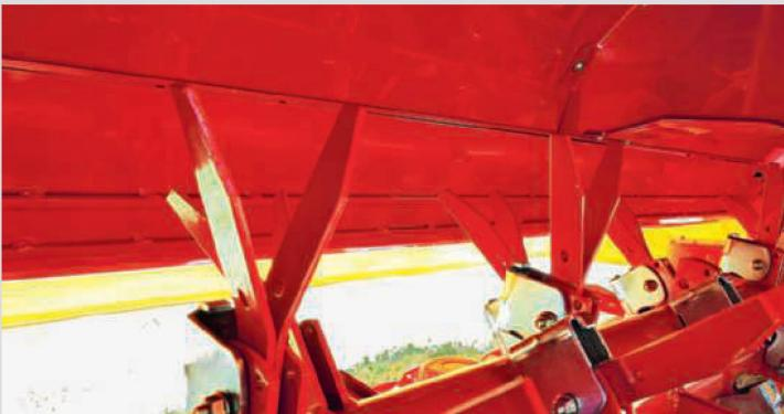
Die Intensität eines Aufbereiter lässt sich durch die Drehzahl und/oder mit der Weite des Durchgangs verstellen. Vorsicht bei Heu: Zu intensive Aufbereitung steigert die Bröckelverluste!
