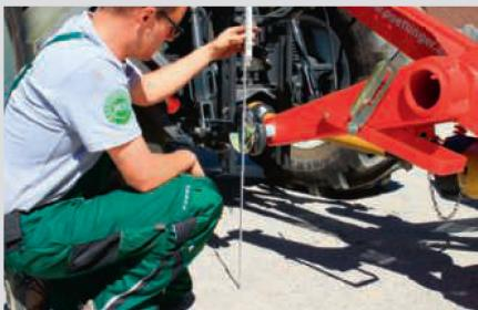
Die Entlastung und die Kinematik beim Heben und Senken des Mähbalkens funktionieren nur bei richtig eingestellter Hubwerkshöhe – Herstellerangaben beachten!
