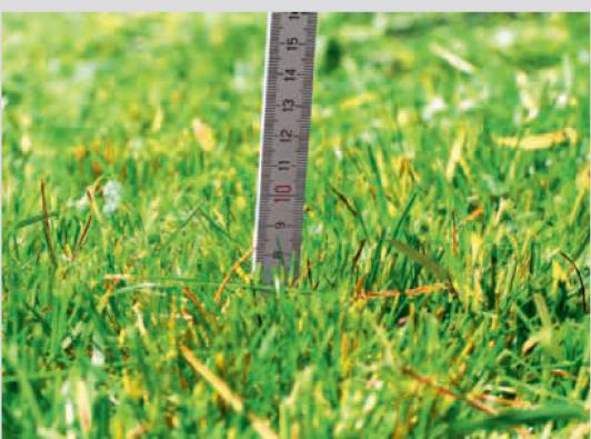
Die Schnitthöhe verändert sich je nach Pflanzenbestand, eingestellter Entlastung und Fahrgeschwindigkeit. Sie muss daher am Feld mehrmals nachkontrolliert werden.
