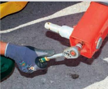
Seitliche Verstellung der Unterlenkerbolzen: Damit lässt sich der seitliche Abstand zu den Rädern und der Überschnitt zum Frontmähwerk einstellen.
