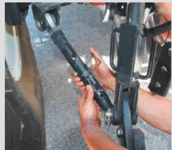
Die beiden Unterlenker beim Heckhubwerk des Traktors müssen mit den Seitenstreben schön zentriert und dann entsprechend fixiert werden.
