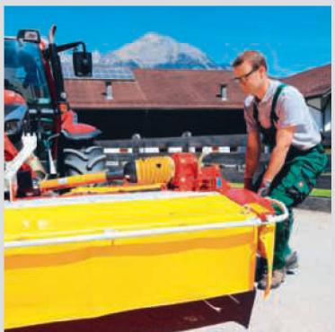
Test der Entlastung durch einseitiges Anheben des Mähbalkens.
