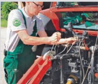
Die Länge des Oberlenkers wird so gewählt, dass das Mähwerk möglichst waagrecht am Boden aufliegt.
