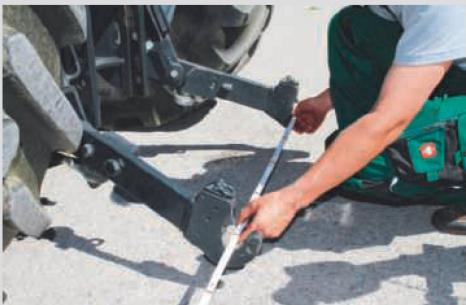
Vor dem Anbau muss man das Spreizmass der Unterlenker mit den Seitenstreben auf die Kategorie des Anbaubocks anpassen. Mit den Hubstreben werden beide Unterlenker auf dieselbe Höhe eingestellt. Bilder: L. Weninger
