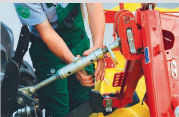
Der Oberlenker muss so eingestellt werden, dass die Trommeln waagrecht stehen. Beim Trommelmäher darf die Schnitthöhe nicht über den Oberlenker eingestellt werden. Das würde zu einem welligen Schnittbild führen.
