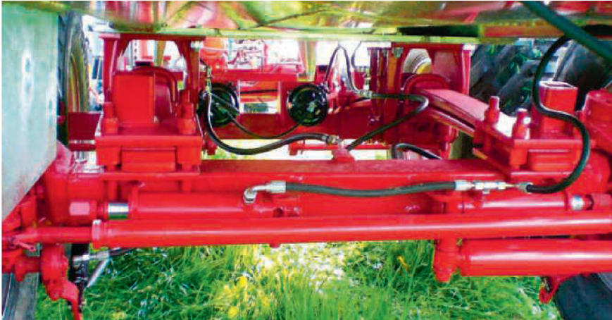
Das ALB-Ventil sorgt dafür, dass die Bremskraft entsprechend der Belastung der Achsen automatisch geregelt wird. Bilder: zVg
