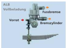
Bei Anhängern mit Parabelfedern wird die Durchbiegung der Feder für den Regelimpuls benutzt. Bei Luftfederungen ist es der Balg-Innendruck.
