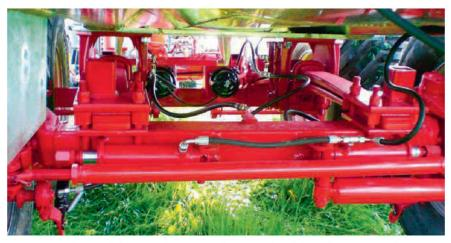
Das ALB-Ventil sorgt dafür, dass die Bremskraft entsprechend der Belastung der Achsen automatisch geregelt wird. Bilder: zVg
