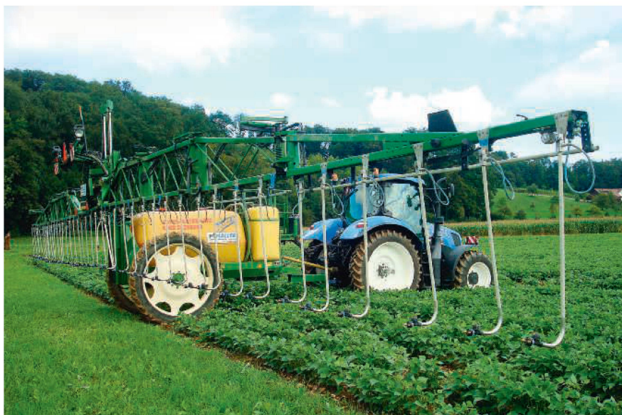
Die Droplegs können als Zusatzausrüstung an konventionellen Feldspritzen am Spritzbalken befestigt werden. (Bilder: Haller Lohnunternehmen, Birrhard)
