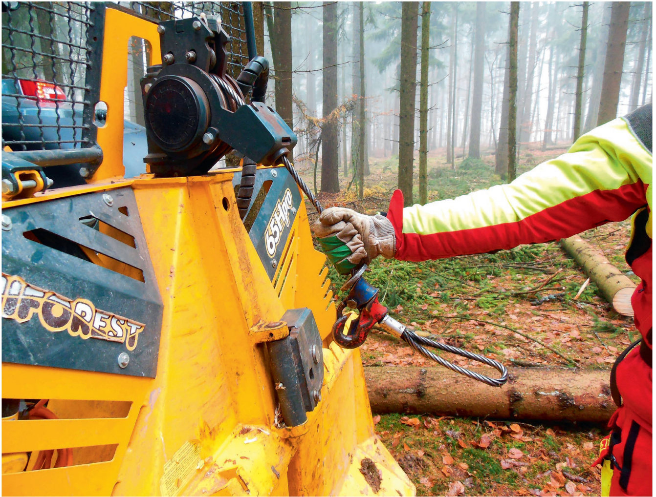
Bedienungsfehler bei der Seilwindenarbeit können schnell zu Quetschungen an den Händen führen. Bild: T. Fottner
