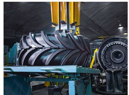
Das Backen (Vulkanisation) bringt den Traktorreifen vom plastischen in den elastischen Zustand.
