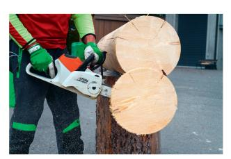
Zur Beurteilung der Schnittleistung wurden an einem Stamm möglichst rasch mehrere Scheiben hintereinander abgesägt.
