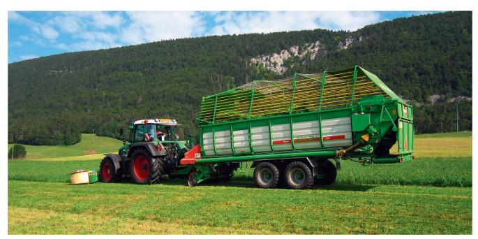
Hohe Intensität: Mit dem Agrar «Bison 552» wird auf dem silofreien Betrieb von Eric Brunnschweiler Heu und Gras für über 100 Stück Vieh eingeführt. Ausgerüstet ist der Ladewagen mit Tandemachse, Dosiereinrichtung und einem Querförderband. Bilder: zvg
