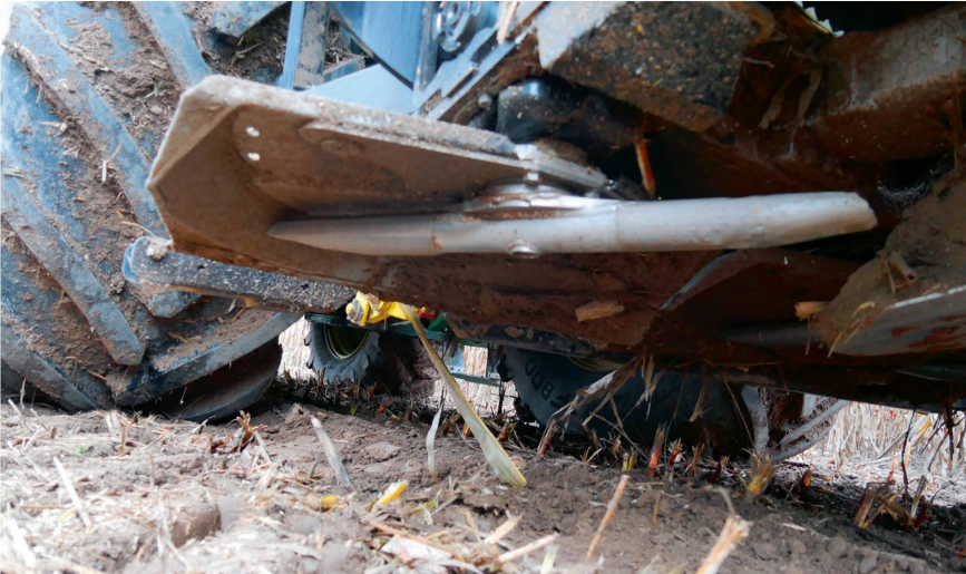
Den «StalkBuster» gibt es vorerst für das 8-Reihen-Maisgebiss Kemper «460 Plus». Die acht Schlegel-einheiten sind pendelnd aufgehängt und werden mit Druckluft am Boden angepasst.
