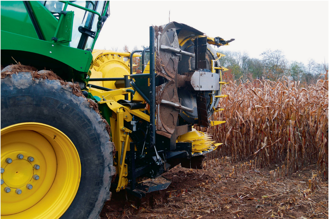
Aufgeklapptes Kemper-8-Reihen-Maisgebiss mit «StalkBuster». Die unmittelbar hinter das Schneidwerk integrierten Schlegelmulcher zerstören die Maisstoppeln, bevor sie von den Rädern plattgedrückt werden. Bilder: H. Röthlisberger
