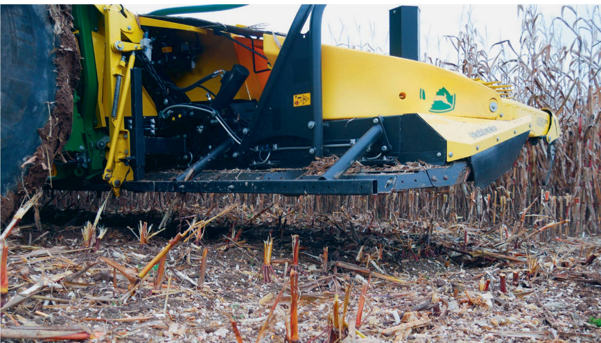
Bei Hochschnittmais wird der obere Teil der Stoppeln zerstört. Im unteren Bereich bleiben die Stoppeln teilweise unversehrt oder nur gering zerfranst.
