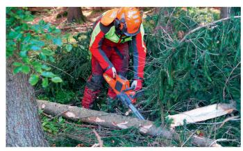
Die Akkumotorsägen werden zunehmend leistungsfähiger und eignen sich immer mehr für den Einsatz im Wald. So etwa für das Entasten.
