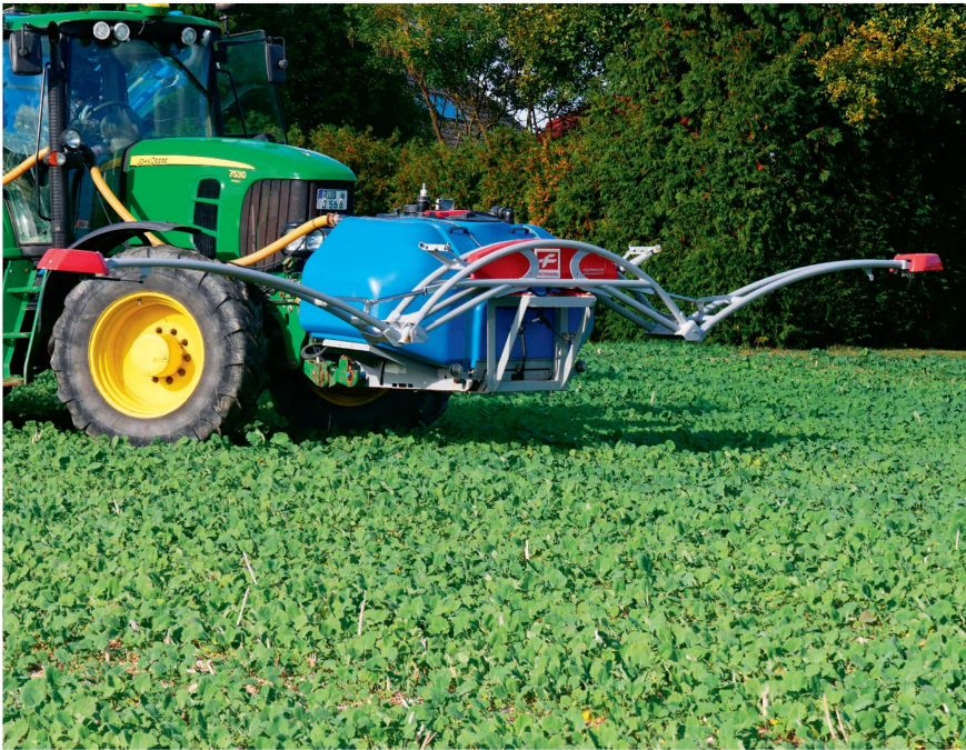
Bei jeder Überfahrt ist der «Isaria»-Sensor dabei, scannt den Bestand und liefert so permanent Informationen für die Optimierung der Bestandeskarten.
