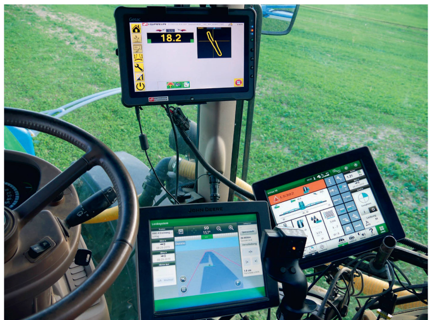
Dank Spurführung und vielen autonom laufenden Funktionen kann sich der Fahrer ganz auf die Überwachung der Arbeitsgeräte konzentrieren.
