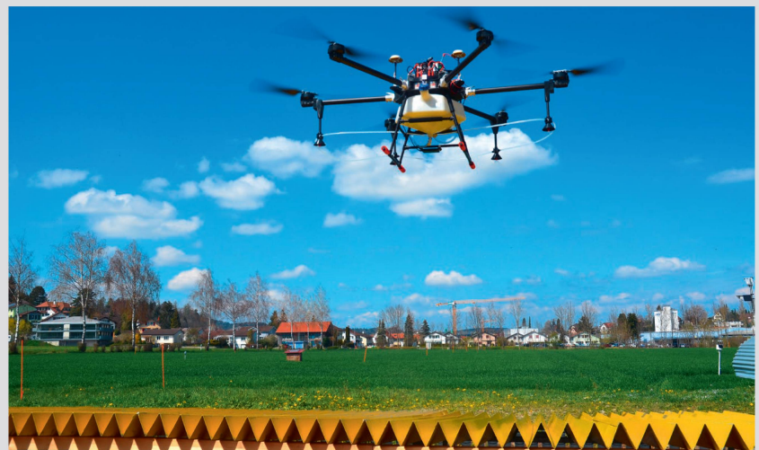
Drohne auf dem Prüfstand für die Messung der Querverteilung. Bild: T. Anken, Agroscope
