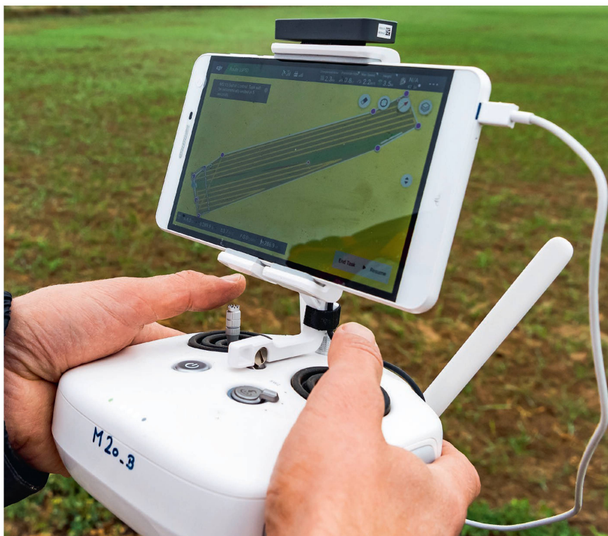
Auf dem Display der Steuerungseinheit sind die vorher berechneten Flugbahnen über dem Feld und die aktuellen Lagekoordinaten der Agrardrohne sichtbar.
