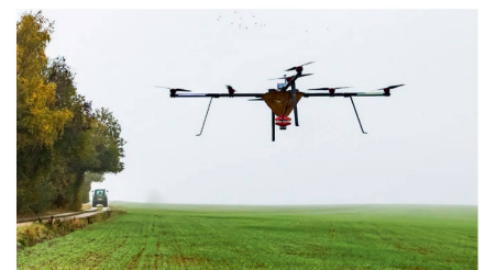
Die Lastendrohne von Agroflight beim Ausbringen von Schwefellinsen. Die Abwurfbreite beträgt 9 m.
