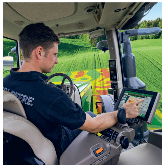
Das von John Deere und Airbus entwickelte «NBalance»-System kann die Stickstoffbilanz live überwachen und nach der Ernte auswerten. Bild: John Deere
