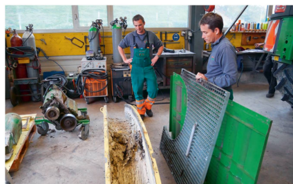
Das Auswurfrohr ist voller Ablagerungen mit Häckselgut.
