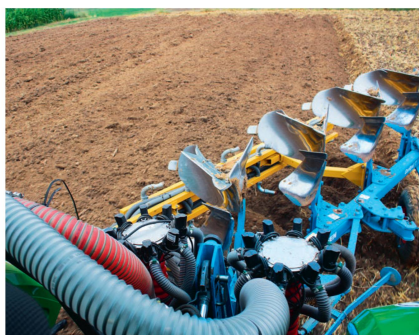
Beim Pflügen werden über zwei Verteilerköpfe die Feinsaaten in obere und die Leguminosen in tiefe Saathorizonte separat und direkt in den Erdstrom eingeblasen.
