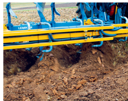
Beim Pflügen werden über zwei Verteilerköpfe die Feinsaaten in obere und die Leguminosen in tiefe Saathorizonte separat und direkt in den Erdstrom eingeblasen.
