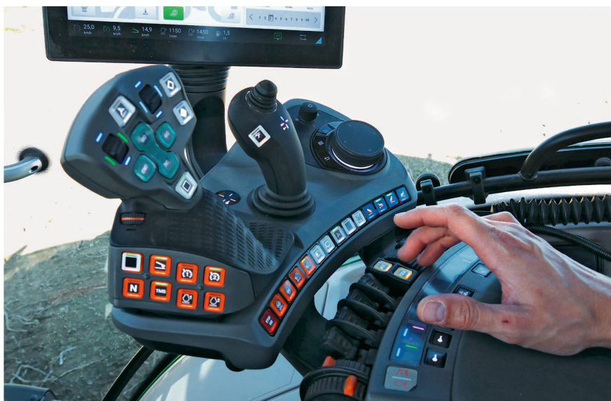
Multifunktionshebel, «3L»-Joystick und Drehdrückknopf sowie viele Tasten: Insgesamt 45 Funktionen lassen sich über die neu konzipierte Armlehne steuern.
