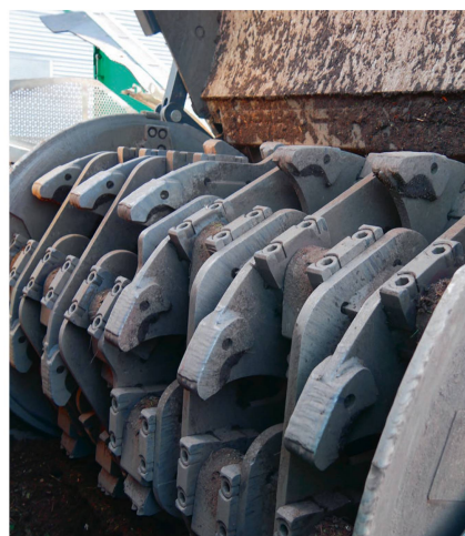
Die Hacktrommel kann mit 32 freischwingernden oder mit 32 feststehenden Werkzeugen ausgerüstet werden.
