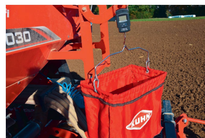
Nach dem Abdrehen kann die Saatmenge bequem und direkt auf der Maschine gewogen werden.
