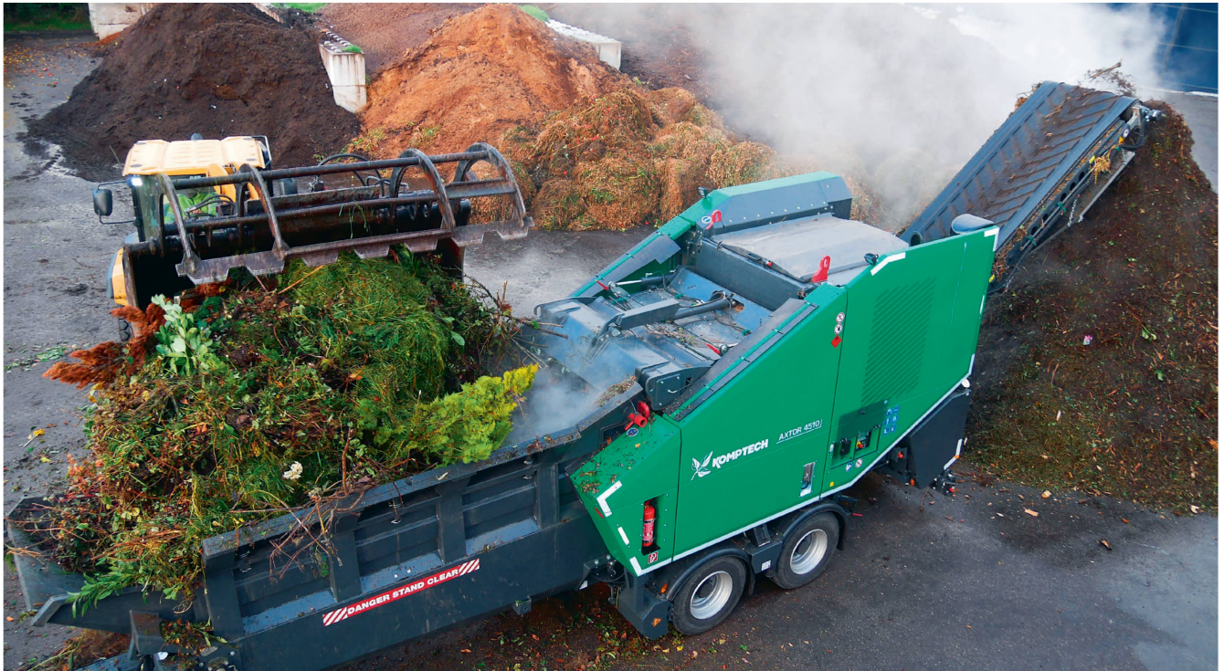
Der «Axtor 4510» mit 462-PS-Motor und 19 Tonnen Gesamtgewicht kann sowohl für das Hacken von Holz als auch für das Schreddern von Grünmasse eingesetzt werden. Bilder: H. Röthlisberger
