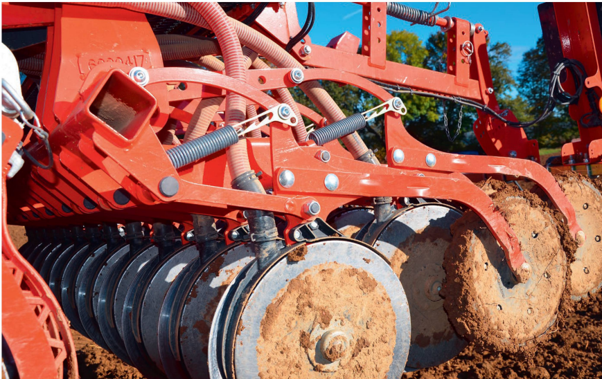
Das «Seedflex»-Säelement verfügt über versetzte Doppelscheiben mit einem Abstand von 35 cm zwischen vorderer und hinterer Reihe.
