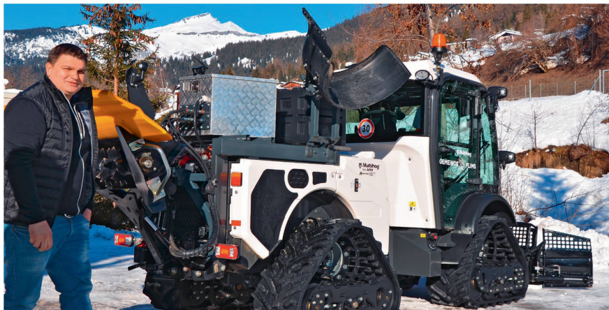
Pirmin Good, Leiter Regionalzentrum Robert Aebi in Landquart: «Die Kotflügel lassen sich seitlich hochklappen.»
