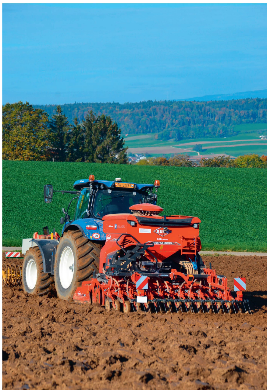
Die Säkombination «Venta 3030» mit Kreiselegge «HR 3030» von Kuhn, wie sie beim Lohnunternehmen Mülli-Kofel zum Einsatz kommt. Bilder: H. Hunger
