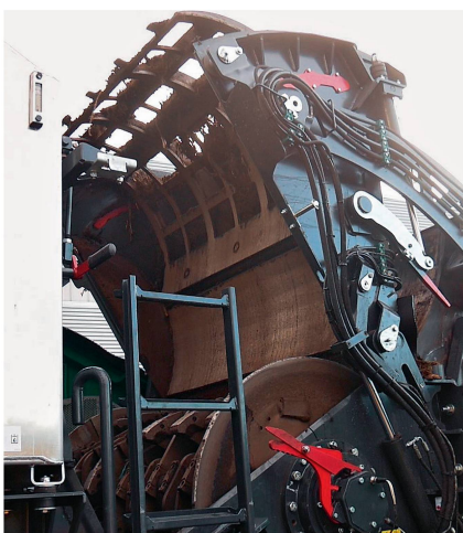
Das hydraulisch klappbare Rotorgehäuse bietet eine sehr gute Zugänglichkeit zu Hacktrommel und Siebkorb.
