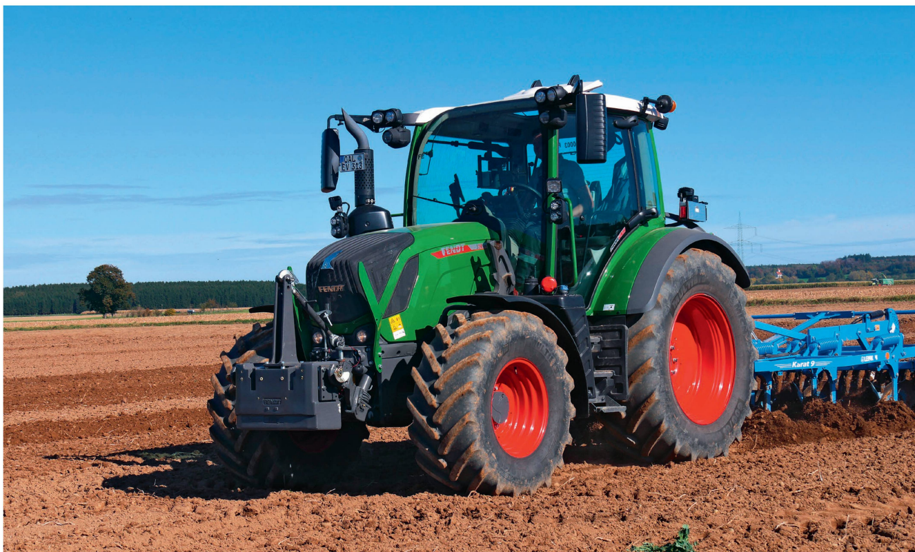
Rein äusserlich – bis auf den wegen des integrierten Partikelfilters dickeren Auspuffstrang – unterscheidet sich der Fendt «314 Vario» kaum von den bekannten Modellen dieser Baureihe. Komplett neu ist hingegen das Bedien- und Mehrleistungskonzept im Innern. Bilder: R. Engeler
