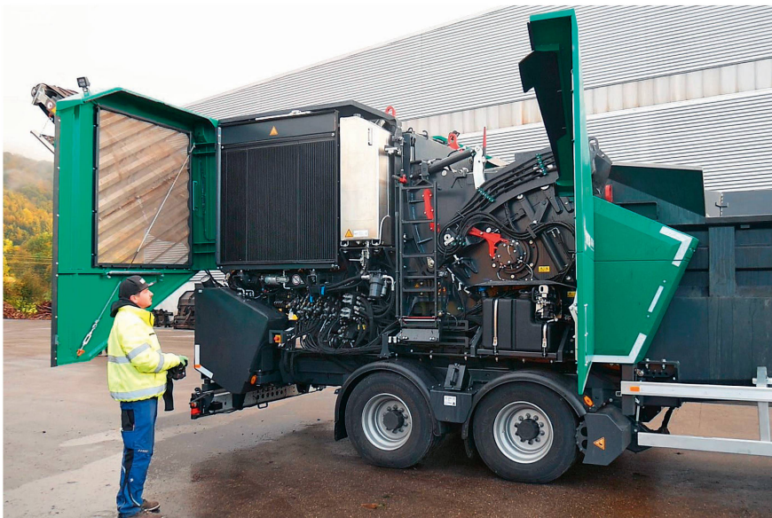
Die Bedienung der Maschine erfolgt mittels Fernsteuerung. Elektro-hydraulisch können das Rotorgehäuse, der Siebkorb sowie die Einzugswalze geöffnet werden.
