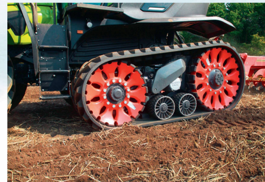
Das «Terra Trac»-Laufwerk beim «Axion» ist vollgefedert und wie bei den selbstfahrenden Erntemaschinen eine Eigenentwicklung von Claas.
