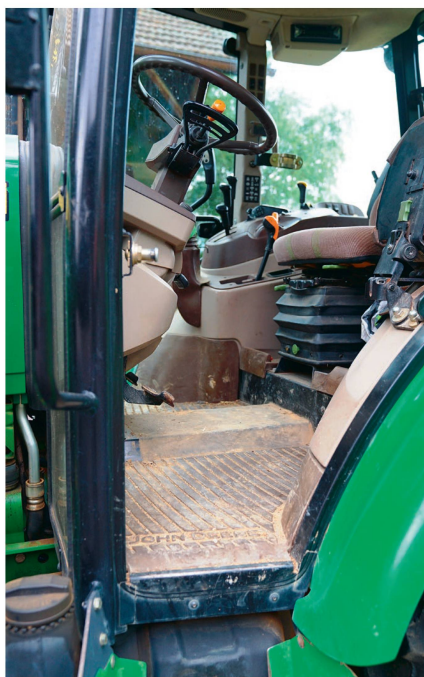
Nicht nur die Kabine selbst, sondern auch der Kabinenboden ist bis auf die Mittelkonsole tiefergelegt.
