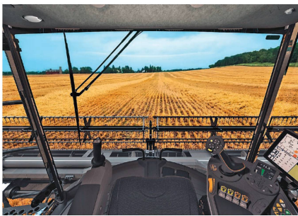
Dieser Mähdrescher «Ideal» von Agco bietet freie Sicht nach vorne, fehlen doch Lenksäule und Steuerrad. Gesteuert wird mit seitlichem Joystick.
