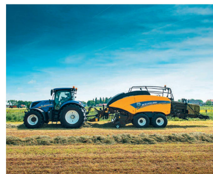
Um Schwingungsbelastungen zu reduzieren, kann man beim New Holland «T7» einen Pressenmodus wählen, womit die Abstimmung der Vorderachsfederung modifiziert, die Motorenkennlinie angepasst und so ein Aufschaukeln vermieden wird.
