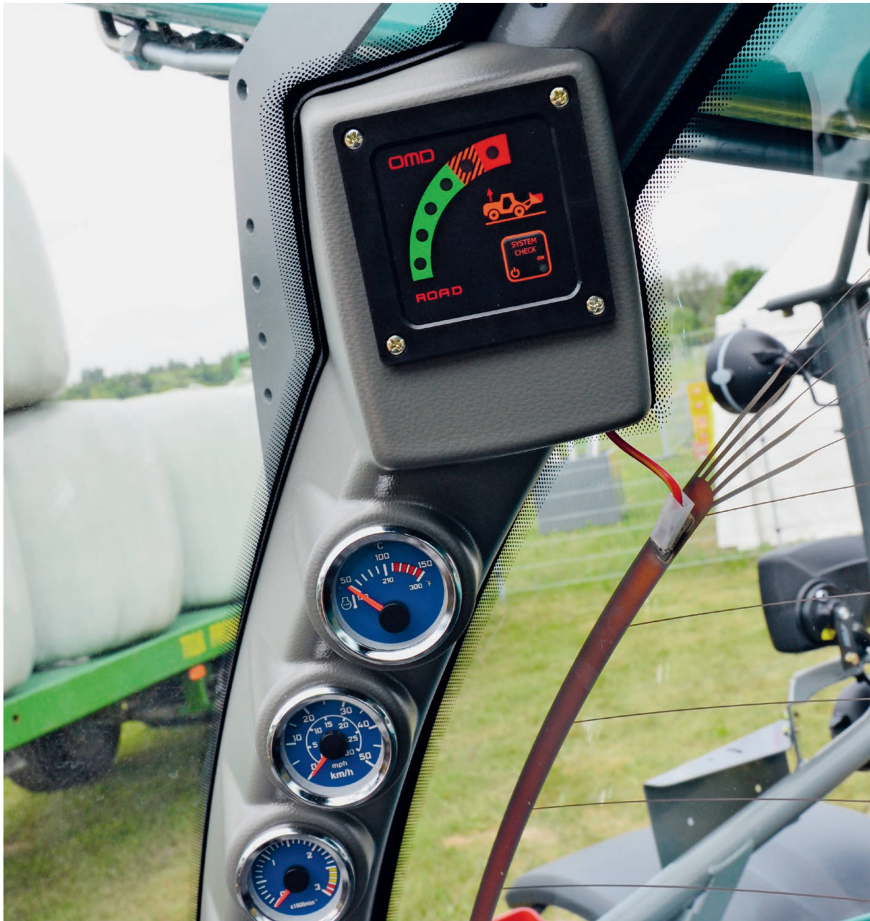
Das System zur Begrenzung des Lastmoments schlägt Alarm, wenn bei einem Teleskoplader die Standsicherheit kritische Werte erreicht. Bild: R. Hunger
