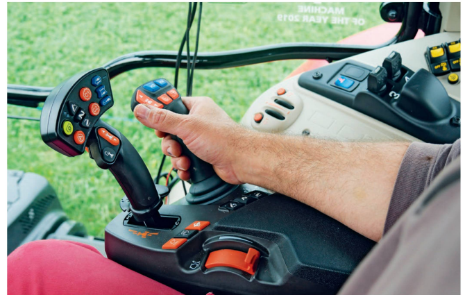
Die Armlehne mit dem «Multipad»-Joystick und dem Steuerhebel, der beispielsweise für Frontladerarbeiten eingesetzt werden kann.
