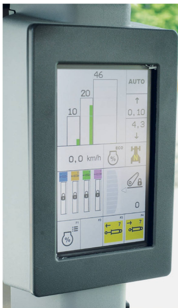
Das «CIS+»-Farbdisplay im A-Holm zeigt in der Standardansicht eine gute Übersicht der aktuellen Einstellungen der drei virtuellen Fahrbereiche.
