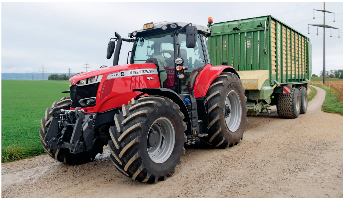
14 Tonnen Gesamtgewicht, 5,5 Tonnen Nutzlast: Der Massey Ferguson «7719 S» mit 6,6-Liter-190-PS-Motor der Abgasstufe 5 und «Dyna VT»-Stufenlosgetriebe ist das neue Spitzenmodell der Serie «7700 S». Bilder: H. Röthlisberger
