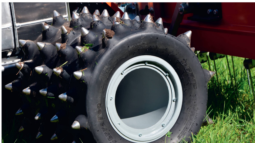
Die «LS Grip Pro»-Stachelwalzen erweisen sich als komfortabel auf fester Fahrbahn und sicher am Hang.
