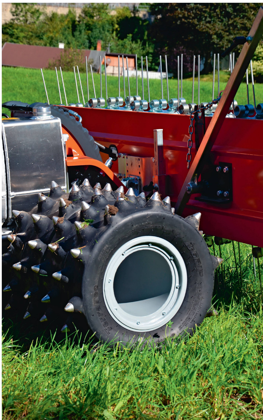
Das neue Luft-Stachelrad «LS Grip» von TerraTec dämpft auf festem Untergrund wie ein Luftreifen und hält im Steilhang wie ein herkömmliches Stachelrad. Bilder: R. Hunger
