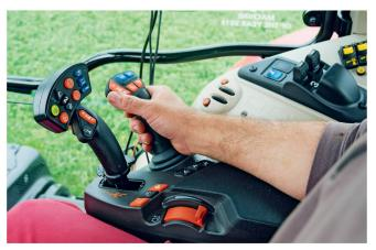
Die Armlehne mit dem «Multipad»-Joystick und dem Steuerhebel, der beispielsweise für Frontladerarbeiten eingesetzt werden kann.
