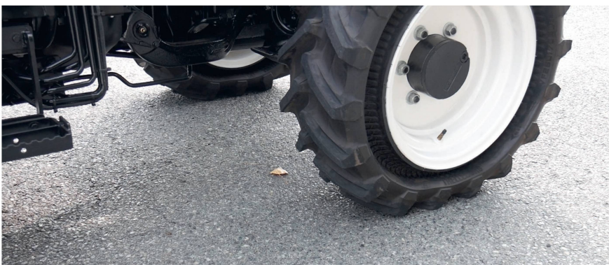
Ausgerüstet mit optionalem «Pneutrac»-Reifen von Trelleborg ergibt sich in Sachen Federung und Bodenschonung ein abgerundetes Bild.
