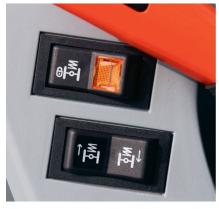
Mit dem oberen Knopf kann die Intensität der Federung, mit dem unteren der Federweg eingestellt werden.
