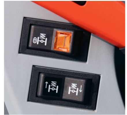
Mit dem oberen Knopf kann die Intensität der Federung, mit dem unteren der Federweg eingestellt werden.
