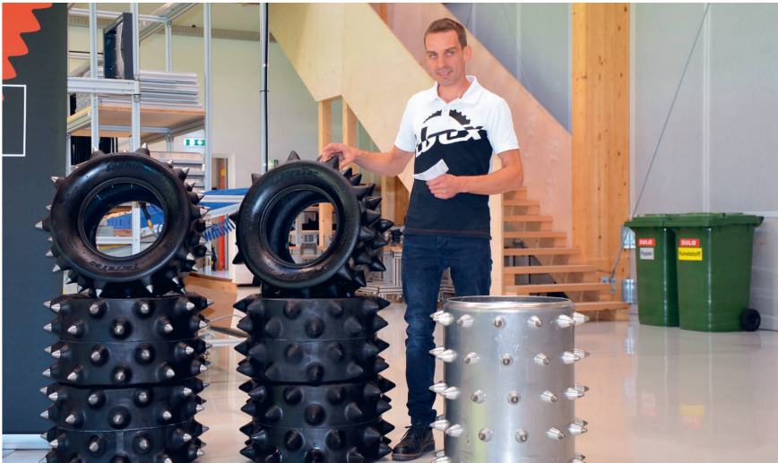
Lukas Schrottenbaum präsentiert den Werdegang: Alu-Stachelrad, Gummi-Stachelrad, Gummi-Stachelrad mit Stahlspitzen (von rechts).
