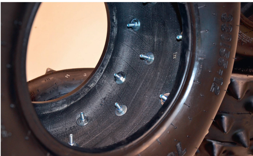
Ungewöhnlich, aber zweckmässig, die Verschraubungen der Stahlspitzen.
