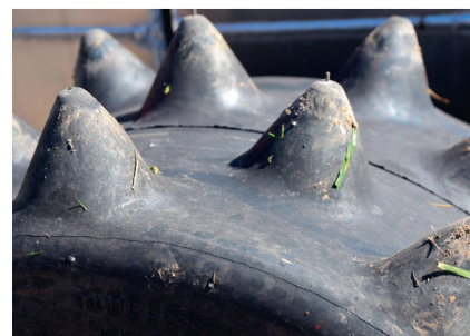
Der «LS Grip Comfort» mit Vollgummistacheln hat vorzügliche Fahreigenschaften auf fester Fahrbahn und an Hanglagen bis 35°.
