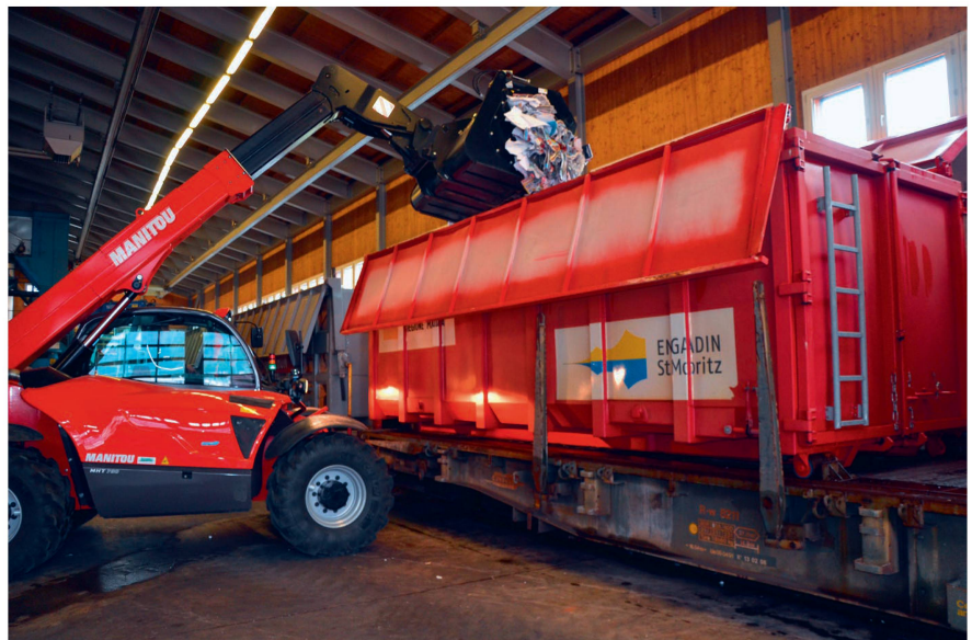
Dank Teleskoparm und Schwanenhals können auch Container auf den Bahnwagen problemlos beladen werden.
