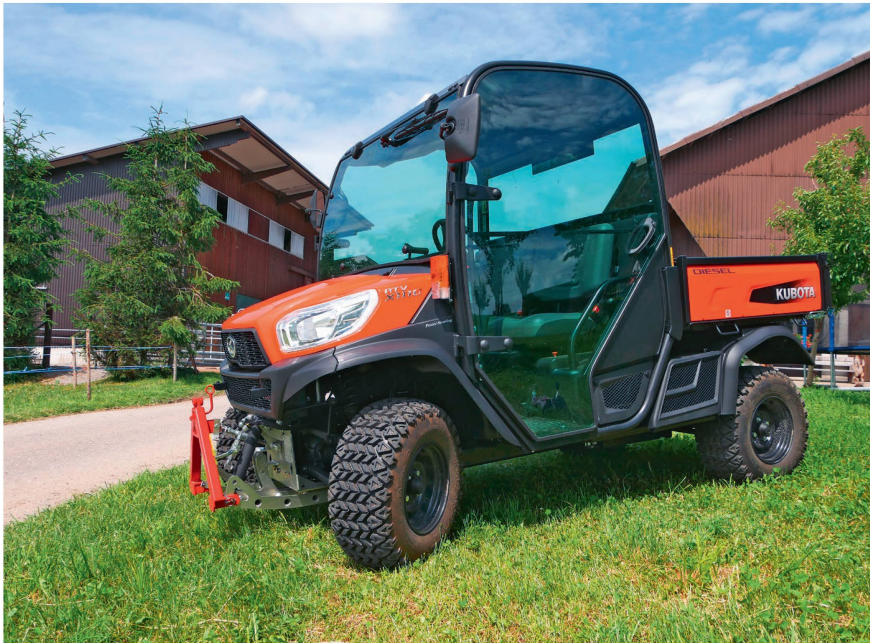
Der Kubota «RTV X1110» verfügt über eine hydraulisch kippbare Ladebrücke. Im Frontbereich gibt es eine Drei-Punkt-Hydraulik. Die komplett geschlossene Kabine bietet einen angenehmen Arbeitsplatz.
