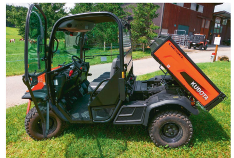
Der Kubota «RTV X1110» verfügt über eine hydraulisch kippbare Ladebrücke. Im Frontbereich gibt es eine Drei-Punkt-Hydraulik. Die komplett geschlossene Kabine bietet einen angenehmen Arbeitsplatz.
