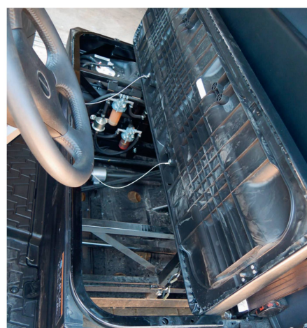
Der Kawasaki «Mule Pro-DX» verfügt über eine durchgehende Sitzbank. Richtig viel Platz bietet die von Hand klappbare Ladebrücke.
