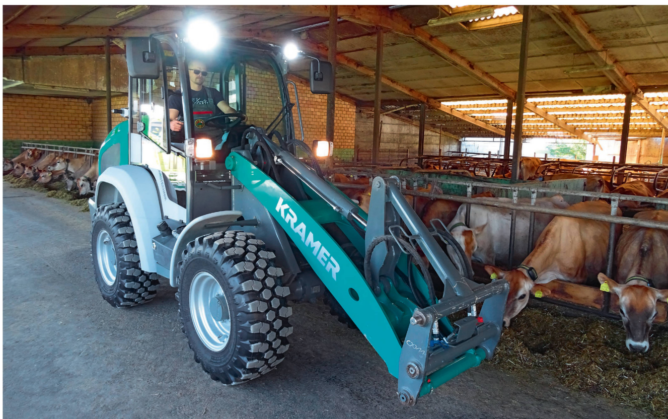
Kramer setzt beim «KL 25.5e» auf Blei-Vlies-Batterien. Die Kapazität dieser AGM-Batterie (Absorbent Glass Mat = saugfähige Vliesmatte) beträgt 416 Ah. Bild: R. Engeler
